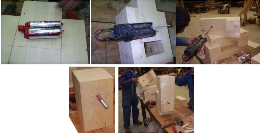
Figura 5-25. Verificación de idoneidad del adhesivo y proceso de montaje.
