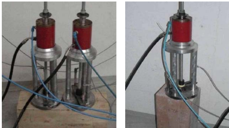
Figura 3-39. Ensayos de extracción en clavijas roscadas pegadas a madera con epoxi Hilti HIT-RE 500 (HILTI Co., 2001).
