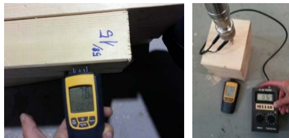
Figura 5-24. Control de humedad y verificación con xilohigrómetro Seltar HGD-1.
