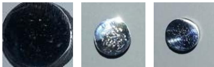
Figura 3-26. Probetas de clavija expuestas a ensayos con durómetro.
