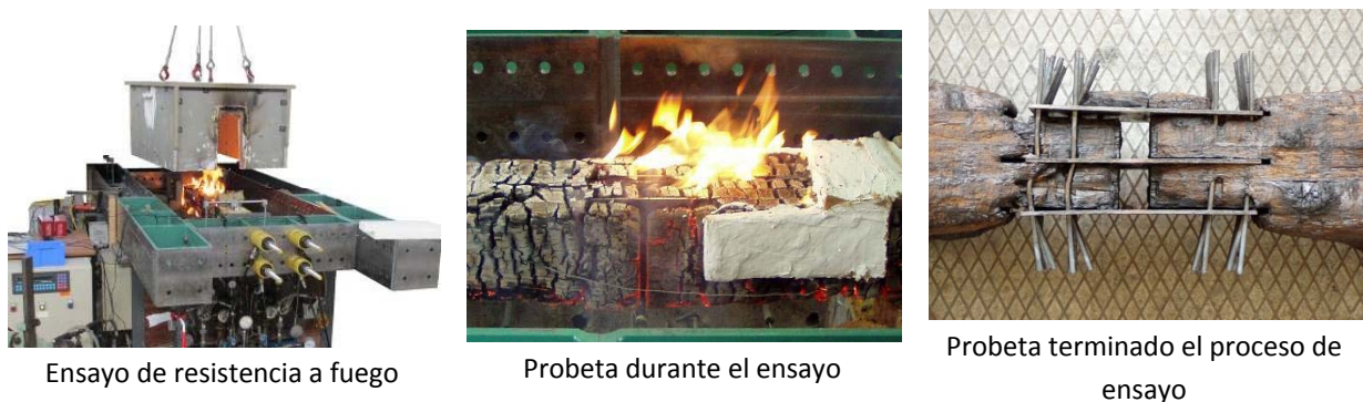
Figura 2-59. Ensayo de resistencia al fuego en unión con clavija (Palma, 2013).
