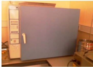
Figura 5-23. Cámaras de acondicionamiento de humedad.
