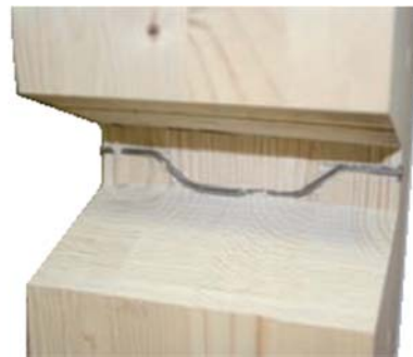
Estado final de la unión de madera con clavija una vez sobrepasada su capacidad de carga (Argüelles, 2010)
