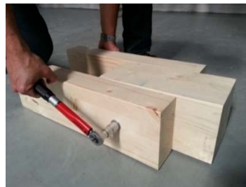
Figura 5-26. Verificación de pretensado en probetas con tuerca-arandela.
