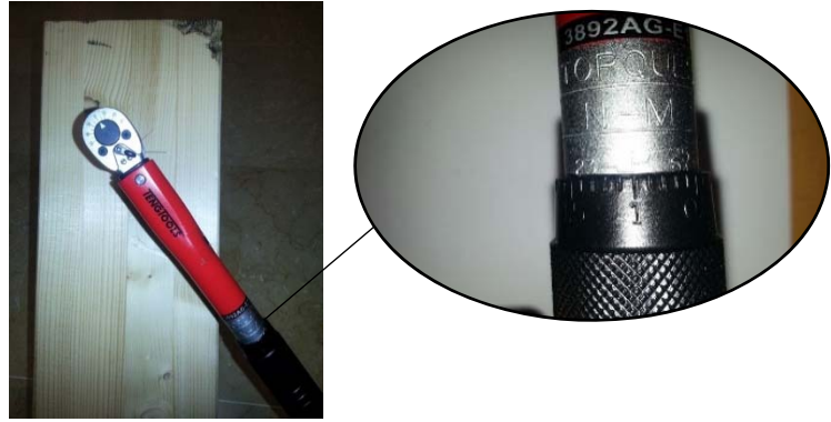
Figura 6-109. Ensayo de resistencia al par torsor.
