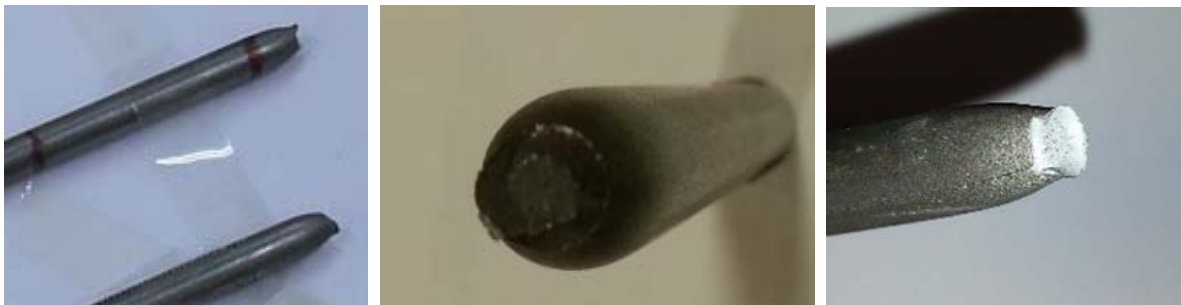
Figura 3-23. Probetas de ensayo a tracción de las clavijas (Acero F111).
