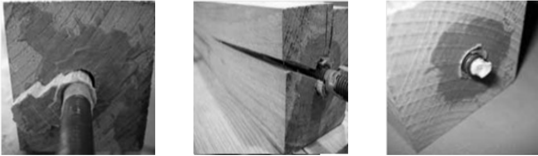
Figura 3-38. Modos de fallo de la unión con adhesivo. Cortante, hendidura y tracción (Otero, 2009).
