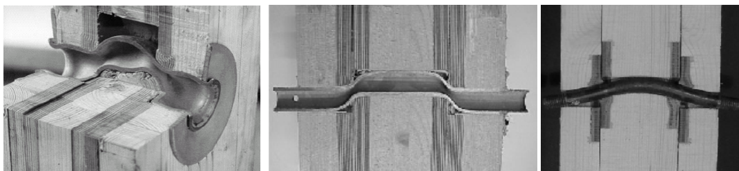
Figura 5-14. Probetas de ensayo en compresión ante fallo por cortadura doble.
