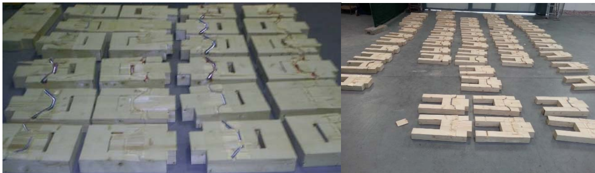
Figura 5-19. Sección transversal de probetas ensayadas en cortadura doble.
