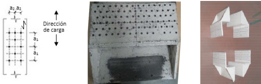
Figura 5-33. Distancias entre los agujeros de varillas en los herrajes de acoplamiento y matriz resultante.
