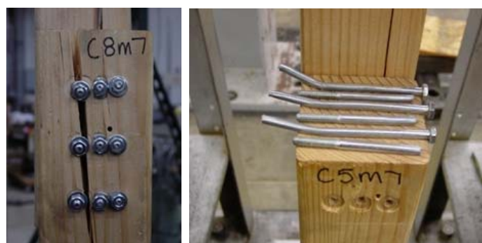
Figura 3-2. Unión con elementos tuerca-arandela y aplastamiento en el contacto madera-arandela (Jesse, 2006).
