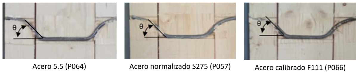
Figura 6-73. Estado de deformación en clavijas roscadas sin refuerzos.
