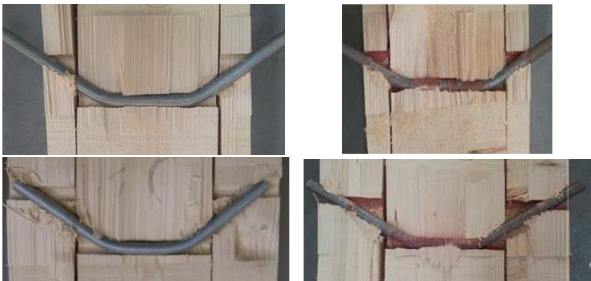
Figura 6-63. Sección transversal de probetas, con distintos espesores de madera lateral ( t_1 ).
