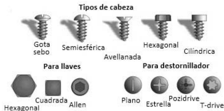
Figura 2-36. Tirafondos y distintos tipos de cabeza.
