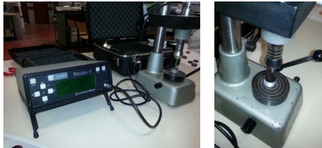
Figura 3-25. Caracterización de acero de clavijas con microdurómetro, según ensayo ISO 6506:2005.
