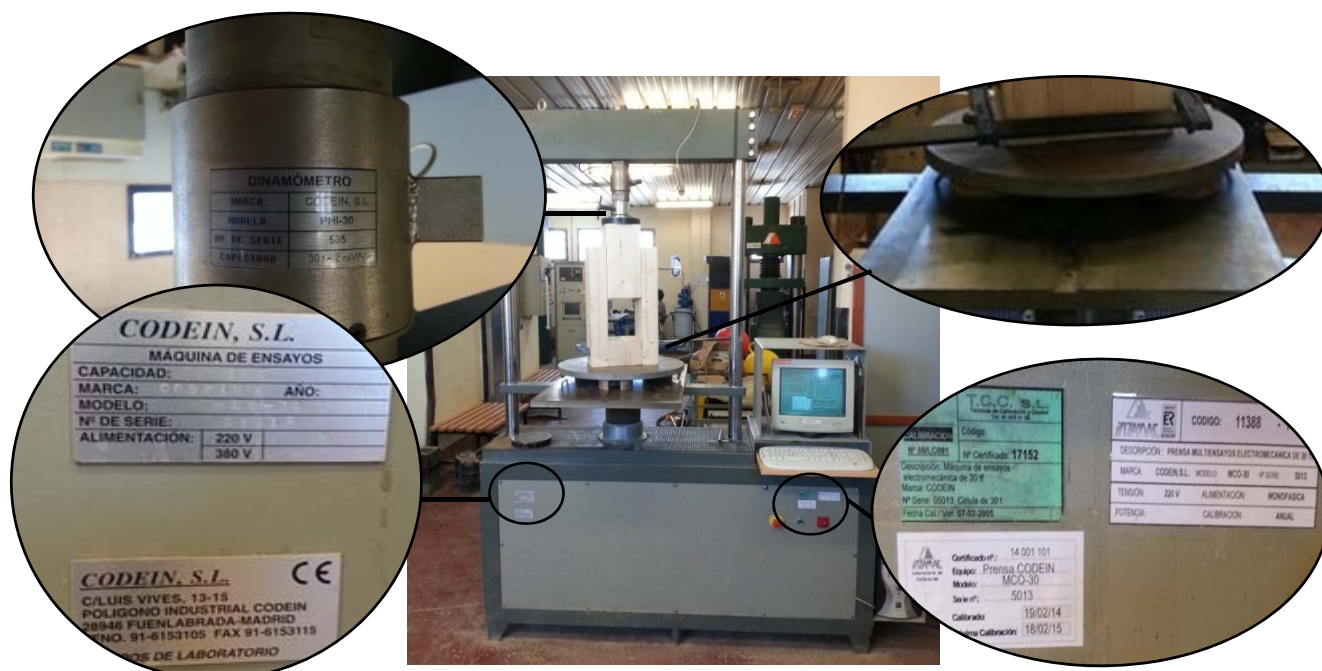
Figura 5-35. Máquina de ensayos Codein. Detalles de célula de carga, balastro de apoyo, certificación y calibración.
