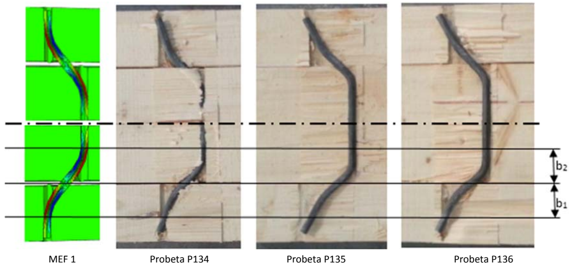
Figura 6-19. Deformación de la clavija en el modelo de elementos finitos inicial (MEF 1) y en la muestra de ensayo [M25].
