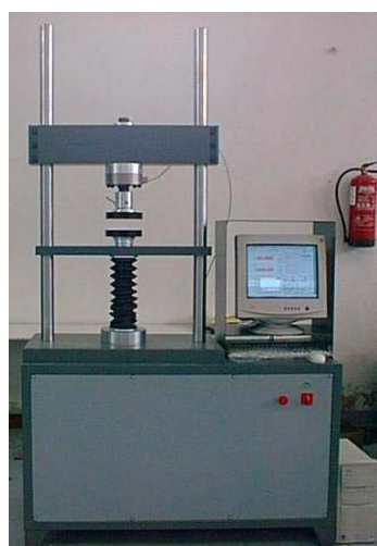
Figura 5-34. Máquina de ensayos Codein 30 para tracción y compresión.
