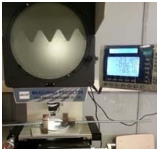
Figura 3-22. Verificación de perfiles con proyector para las varillas roscadas.
