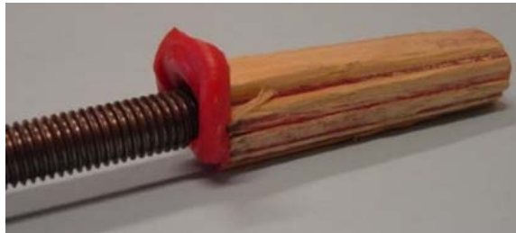
Figura 3-35. Varilla roscada M12 con adhesivo y fallo por desgarro en la madera (HILTI Co., 2001).
