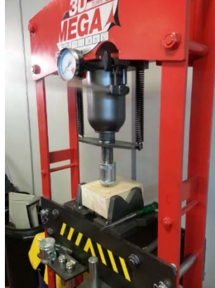
Figura 3-67. Prensa empleada en el proceso de expansión.
