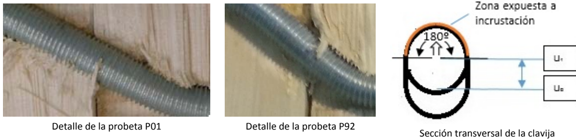
Figura 6-117. Evolución de la incrustación de fibras en las irregularidades de la clavija.
