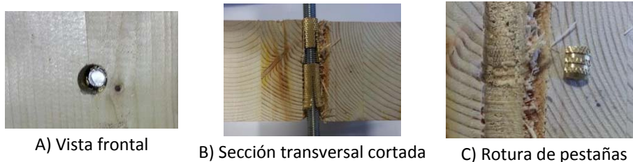
Figura 3-55. Montaje del elemento clavija en pieza de madera.
