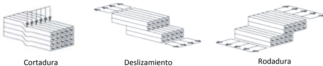
Figura 2-13. Modos de fallo por cortante (Argüelles et al., 2003).
