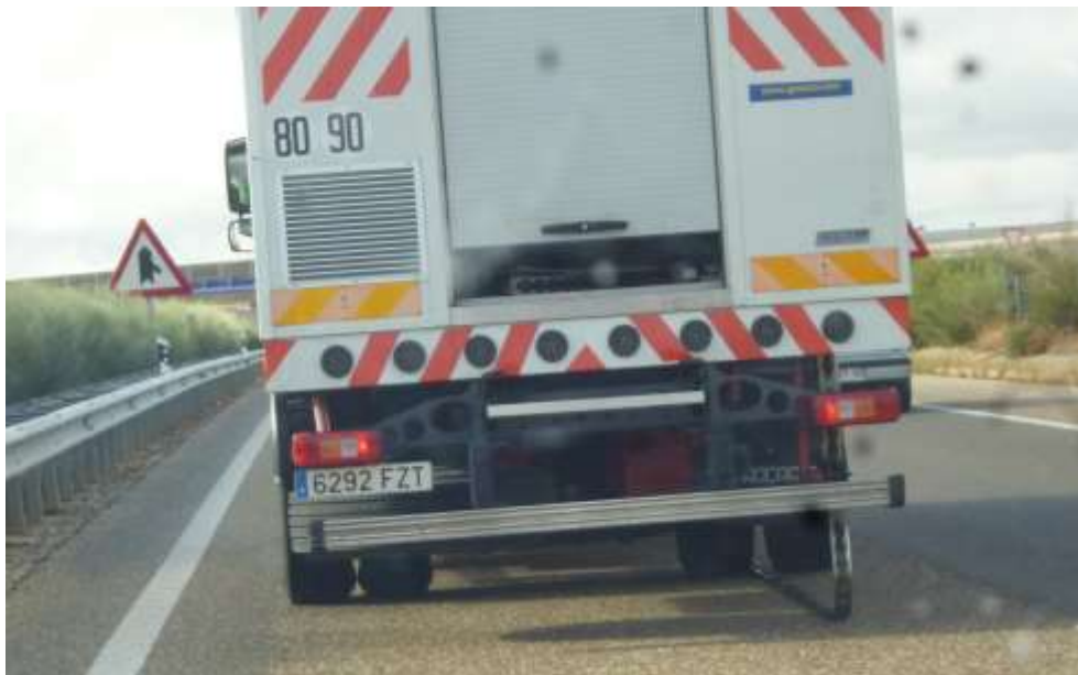
Fig. 5.11. Toma de datos de las deflexiones mediante curviámetro.
