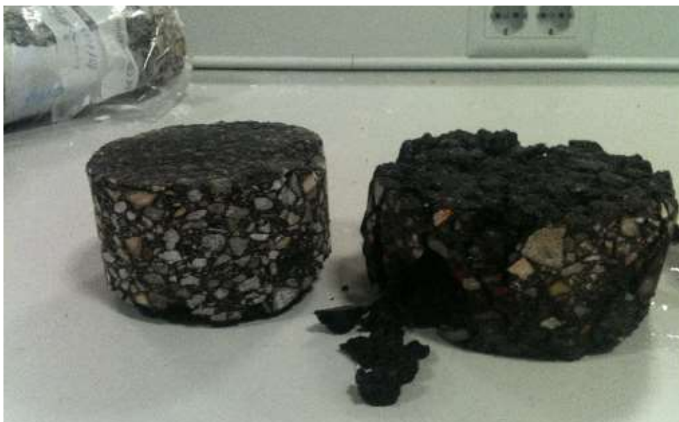
Fig. 5.26. Testigo no sumergido (izqda.) y testigo sumergido en agua durante 35 días (dcha.), (BBTM11A B50/70).
