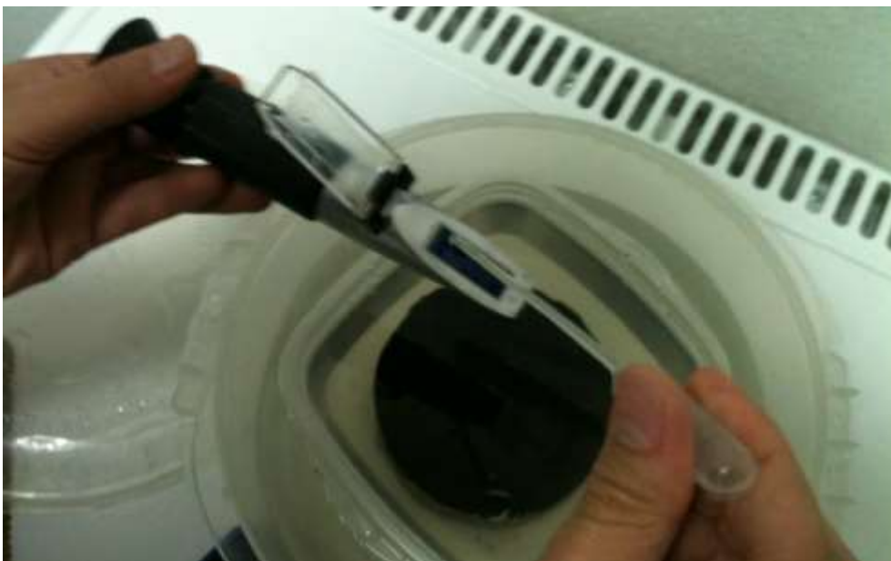
Fig. 5.12. Control diario de la concentración de NaCl en la solución salina.
