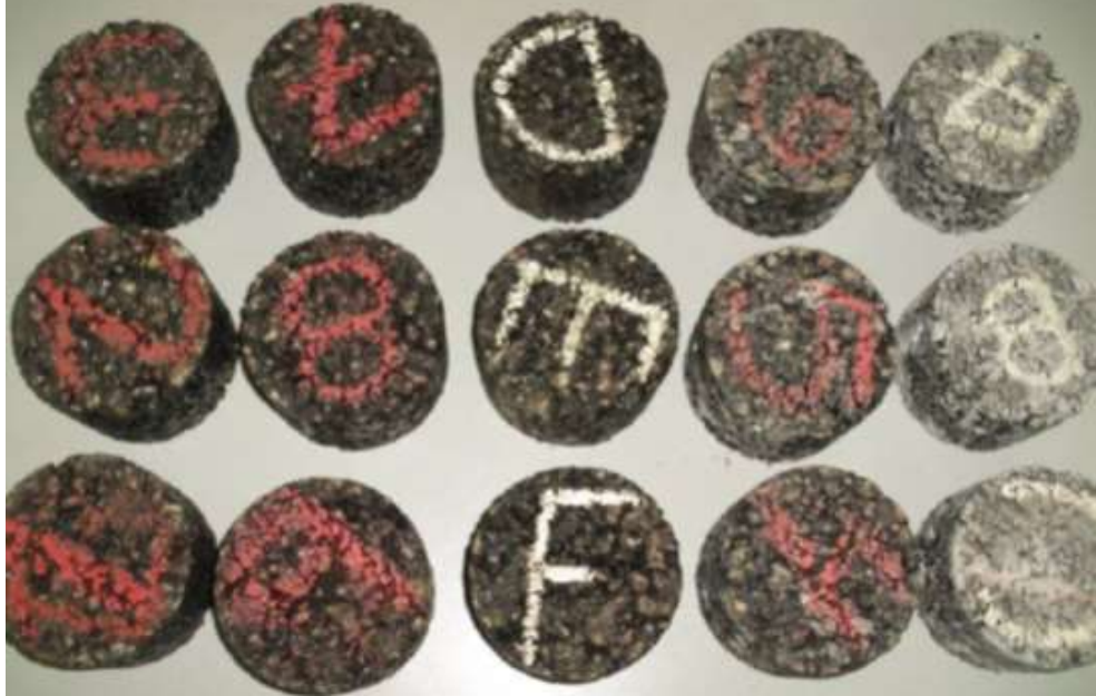
Fig. 5.10. Muestra de las series de algunas probetas ensayadas. De izquierda a derecha: probetas de referencia, en agua, en agua-ciclos, en salmuera y en salmuera-ciclos.
