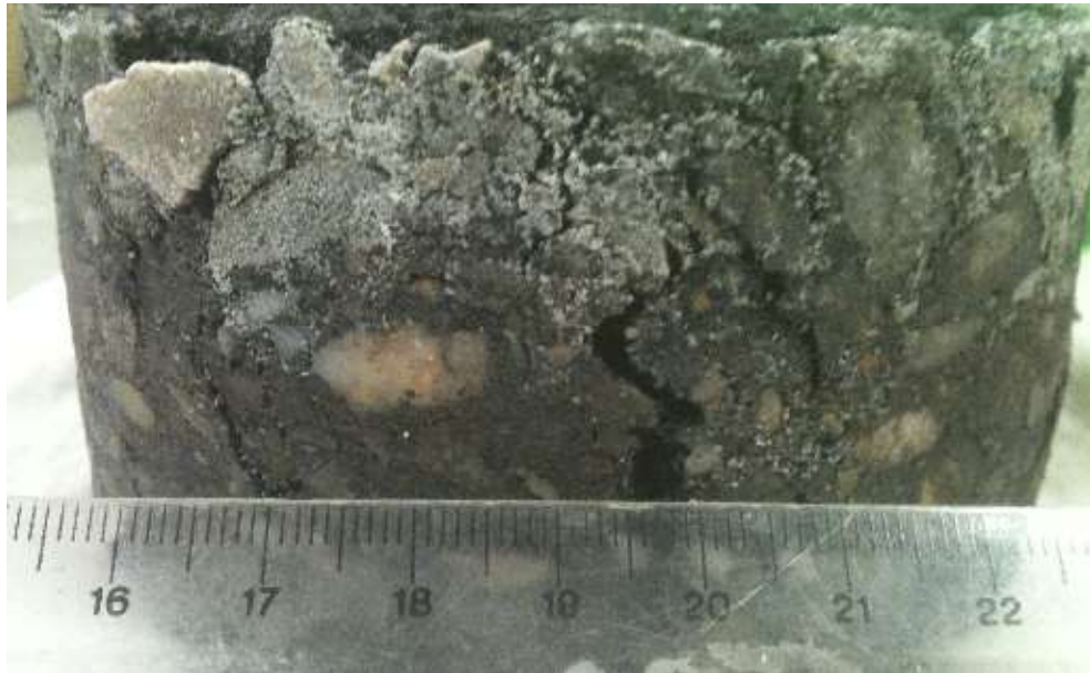
Fig. 5.24. Fisuras en los testigos sumergidos en solución salina (tercer día), (BBTM11A B50/70).
