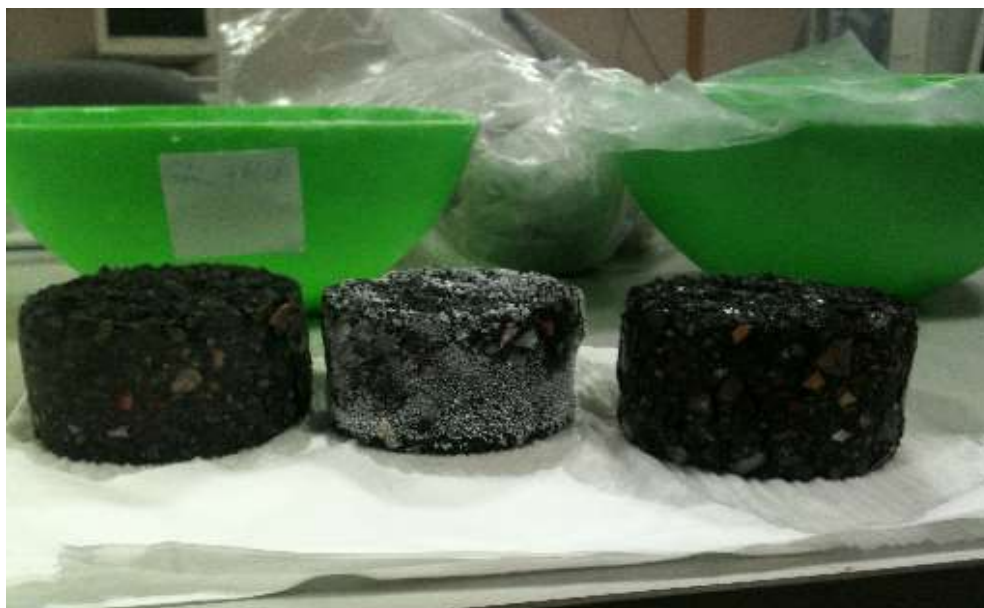
Fig. 5.25. Testigos sumergidos durante 7 días, (BBTM11A B50/70). De izqda. a dcha.: en solución salina a 4°C, en solución salina a 23°C y en agua a 23°C.
