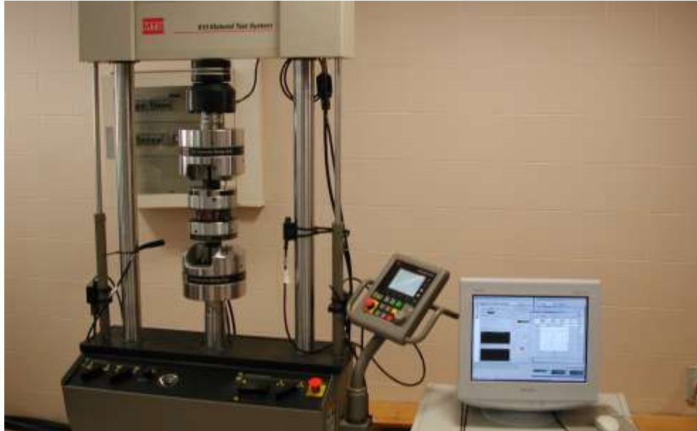
Fig. 4.10. Máquina de ensayos a compresión simple utilizada para ensayos tanto estáticos como dinámicos.
