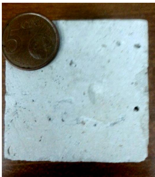
Fig.2.1. Probeta cúbica de caliza 5x5x5 cm
