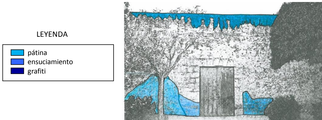
Fig.4.20. Alzados Norte del alcázar. Patologías presentes en el monumento
