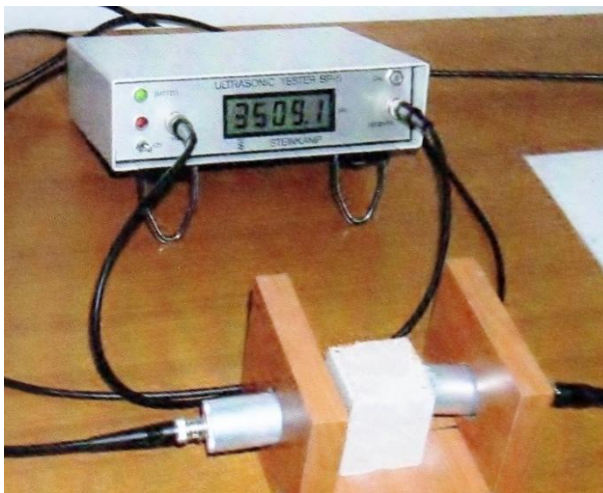
Fig.2.10.Medidor de la velocidad de propagación de ultrasonidos utilizado y direcciones en las que se toman las velocidades V_x, V_y y V_z .
