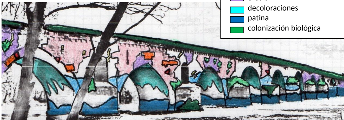
Fig.4.41. Alzado Oeste puente románico. Patologías presentes en el monumento
