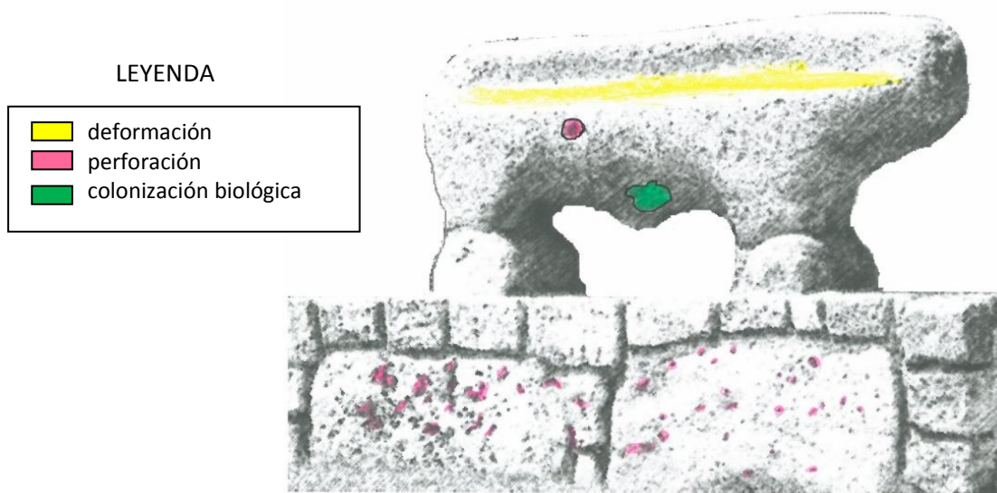
Fig. 4.4. Alzado Este Verraco o Toro de piedra. Patologías presentes en el monumento.
