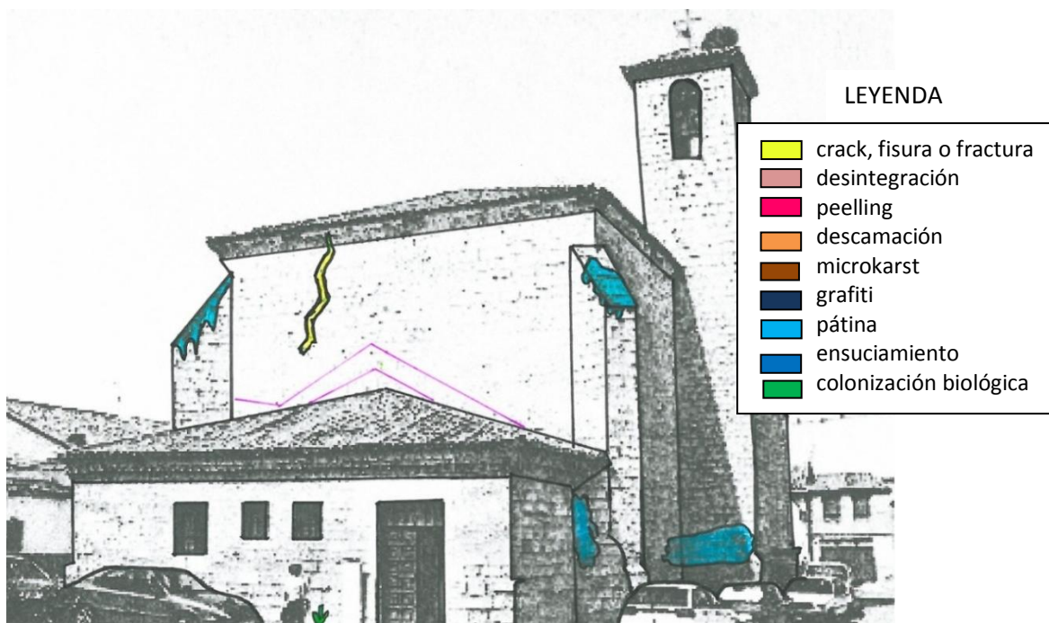
Fig. 4.98. Alzado Este San Sebastián de los caballeros. Patologías presentes en el monumento
