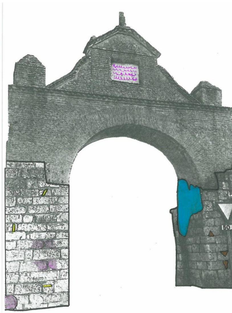
Fig. 4.12. Puerta Oeste Arco de Santa Catalina. Patologías presentes en el monumento
