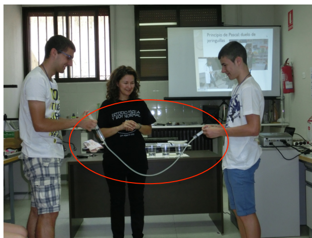
Fig 3.- Experimento para comprender el Principio de Pascal con dos jeringas de plástico, de diferente tamaño, conectadas por un tubo de silicona y lleno el sistema de agua.
