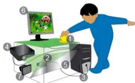
Figura 1. Estructura del tabletop NIKVision
