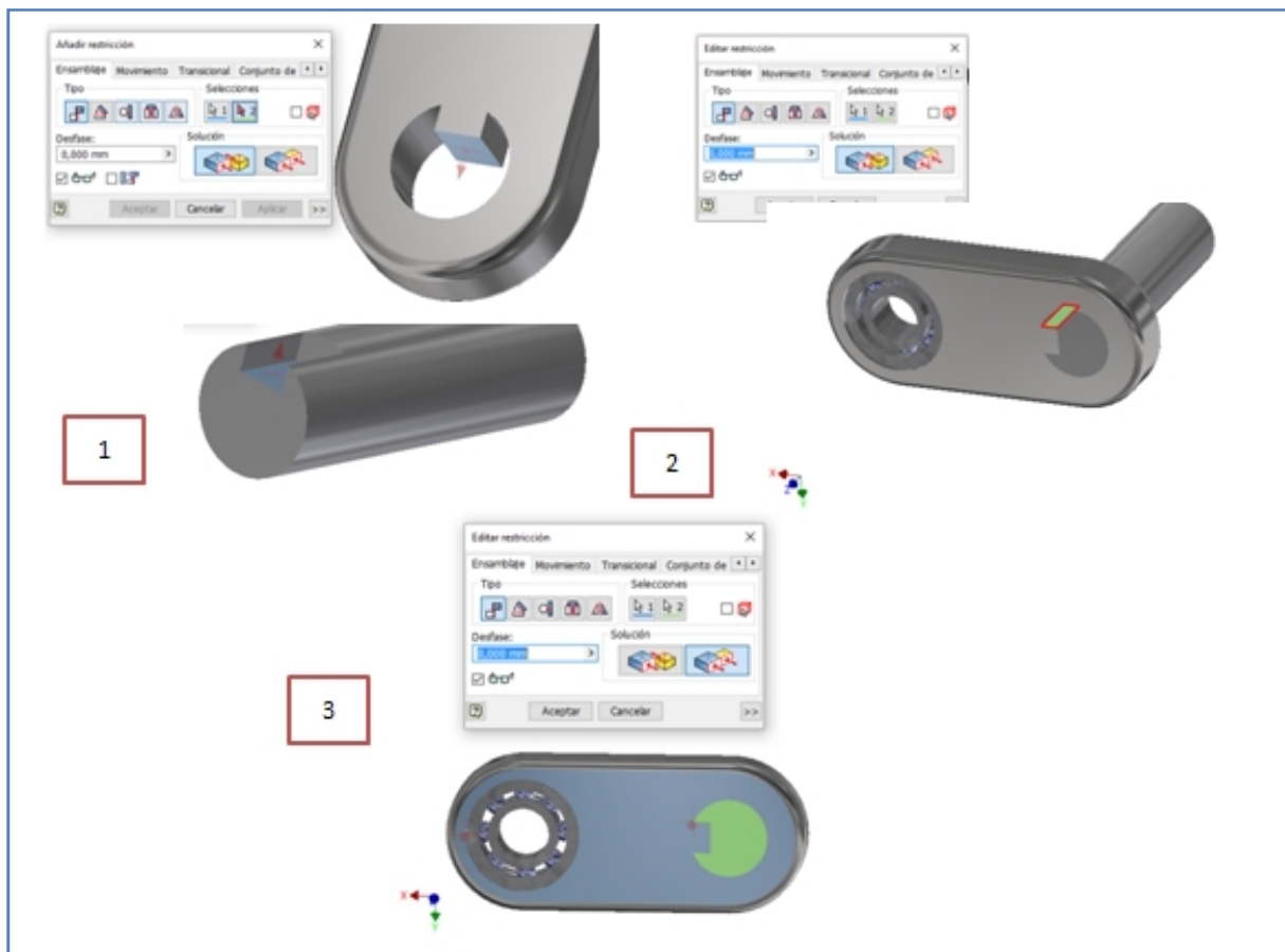
Figura 4.46. Aplicación de restricciones necesarias para unir el eje del motor a la barra AB.
