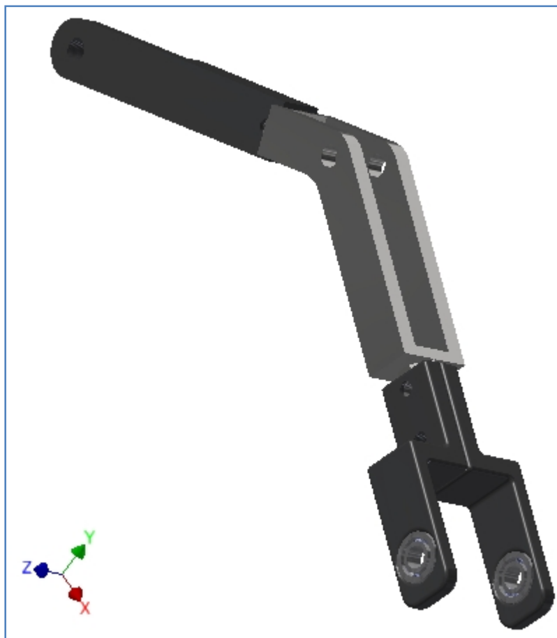
Figura 4.48. Representación de la barra 3 que une los puntos BCD del mecanismo.
