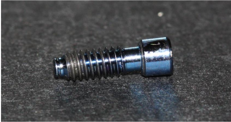
Figura 43. Tornillo Estándar para conexión externa tras 50000 ciclos de masticación simulada
