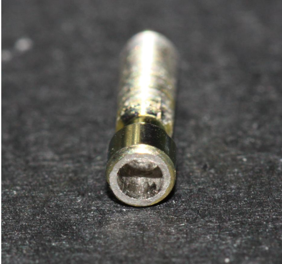
Figura 48. Tornillo Star con hexágono completamente destruido por deformación plástica del metal. Este tornillo tuvo que ser extraído del implante
