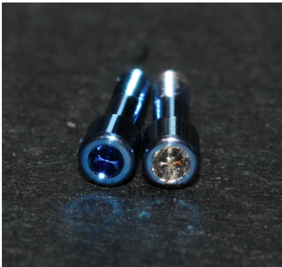
Figura 49. Tornillos Estándar de conexión interna. El tornillo que se encuentra a la izquierda presenta un hexágono de la cabeza normal, mientras que el de la derecha muestra un hexágono deformado plásticamente
