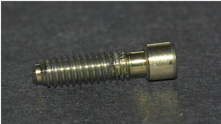
Figura 42. Tornillo Star para conexión externa tras 50000 ciclos de masticación simulada
