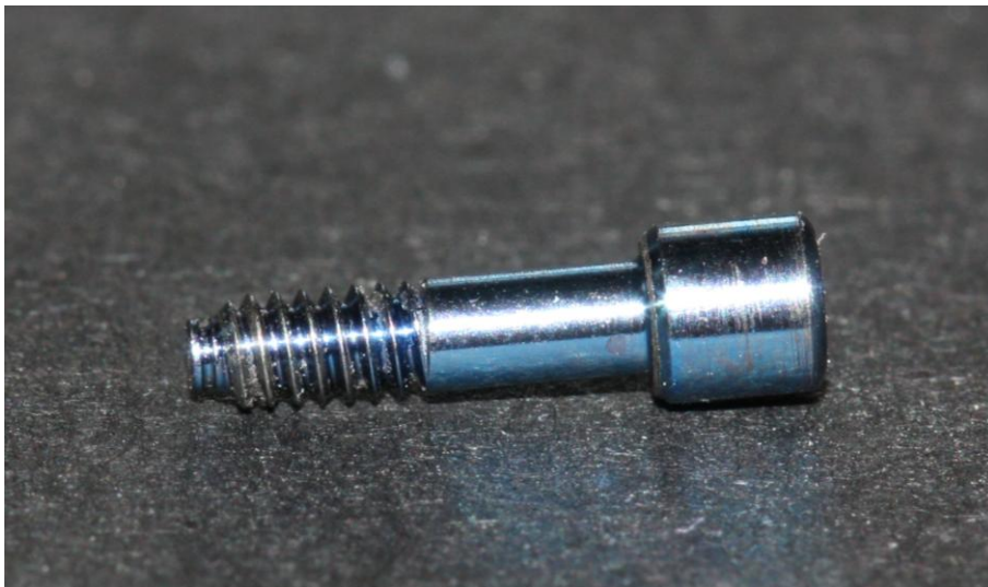
Figura 44. Tornillo Estándar para conexión interna tras 50000 ciclos de masticación simulada
