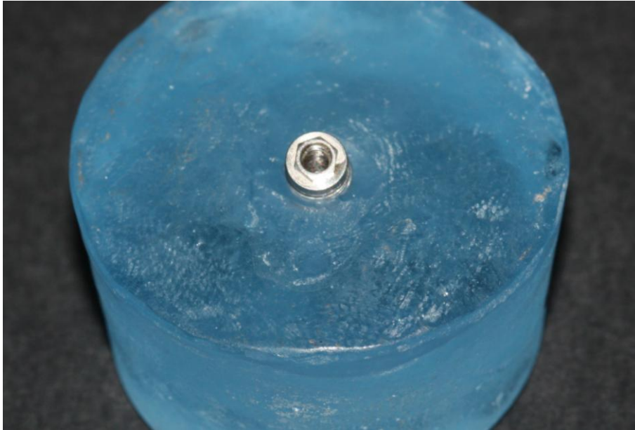
Figura 8. Implante de conexión externa colocado en el interior de la resina
