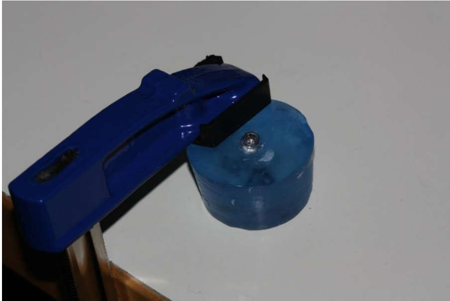
Figura 16. Fijación de la muestra a la mesa para evitar su rotación para la medición del torque de remoción del tornillo
