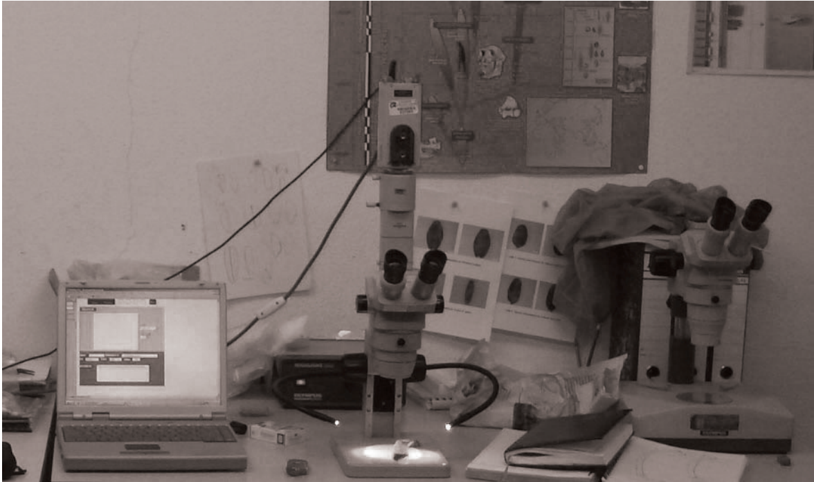
Fig. 1.1. Lupa binocular empleada en el estudio del material óseo reproducido en el programa experimental desarrollado. En la lupa se ha insertado una cámara digital que permite la captación de imágenes a tiempo real y éstas son almacenadas en un ordenador portátil, dotado de un programa para el tratamiento de imágenes que permite la inserción de una escala, entre otros.
