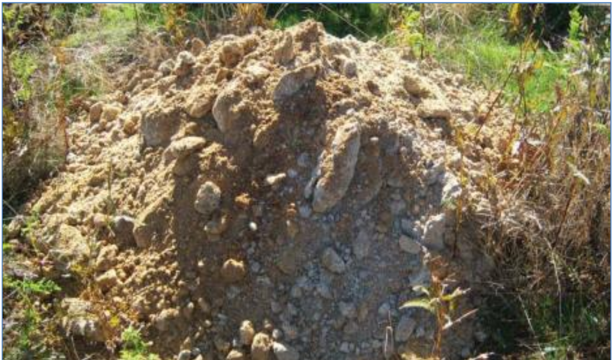
Fotografía 6: Detalle del acopio de material extraído durante la excavación de la calicata C-1
