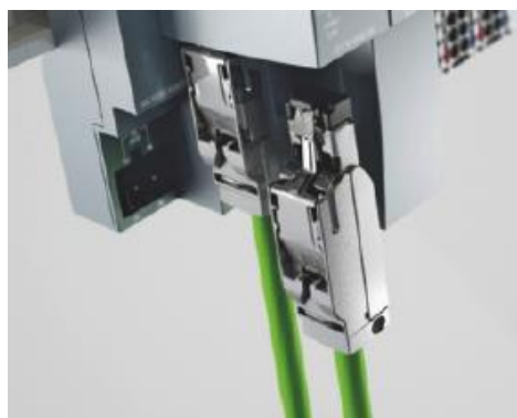
MIII. Fig. 9 ET200SP. Conexión Profinet
