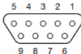
MII. Fig. 7 Conector para control local MAG DRIVE S. Numeración.
