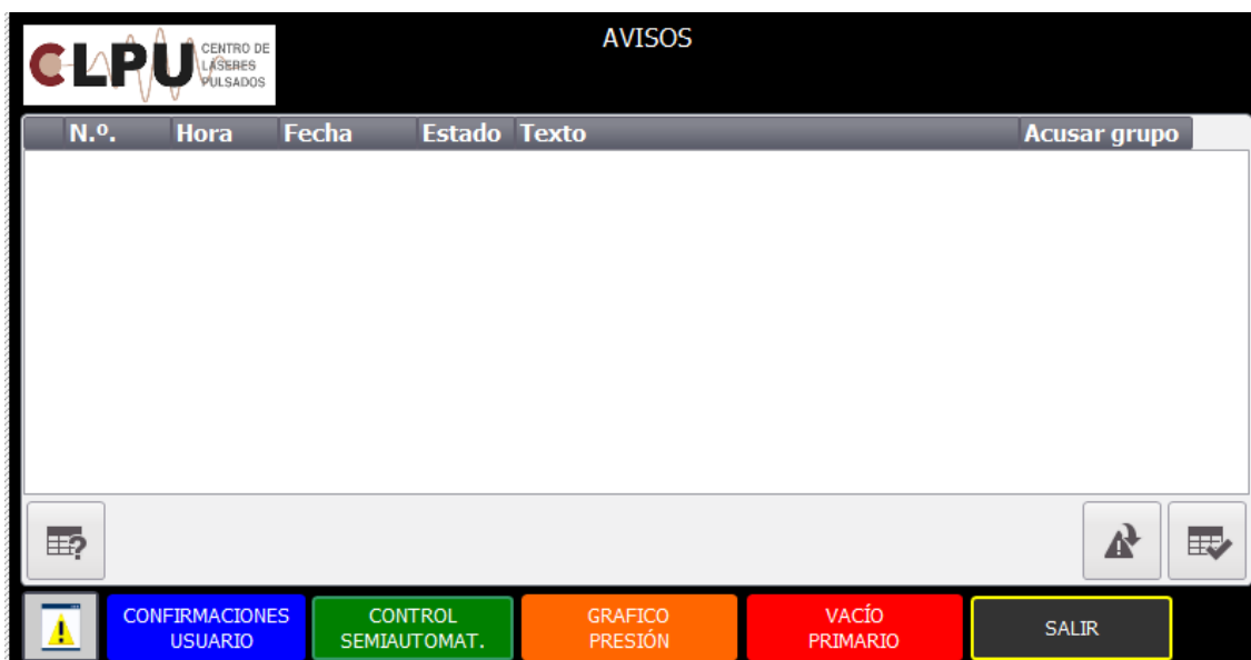
MIV. Fig. 53 SCADA. Registro de alarmas
