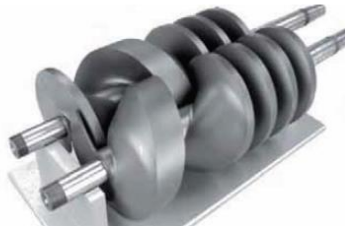
MI. Fig. 1 Rotores en forma de tornillo (screw)
