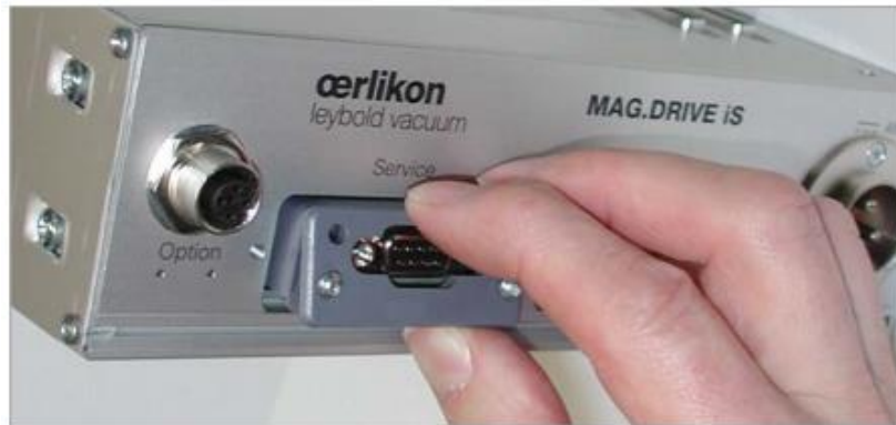
MII. Fig. 6 Convertidor de frecuencia. MAG DRIVE S. Casilla de servicio.
