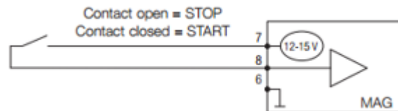
MII. Fig. 9 Control local MAG DRIVE S. Encendido/ apagado de la bomba.
