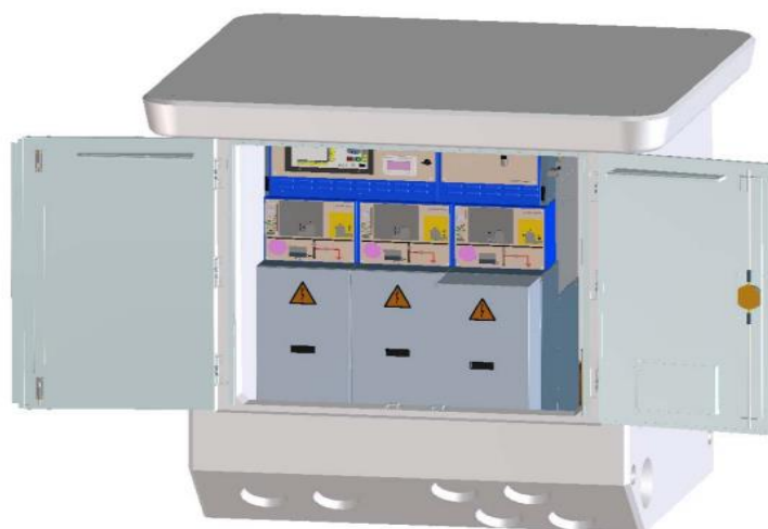
Ilustración 5: Centros de maniobra y seccionamiento CMS. 15
