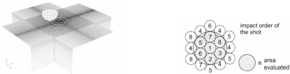
Figura 3.7.- a) Modelo de simulación y b) sistema de cobertura propuesto por SCHWARZER ET AL. (2002)
