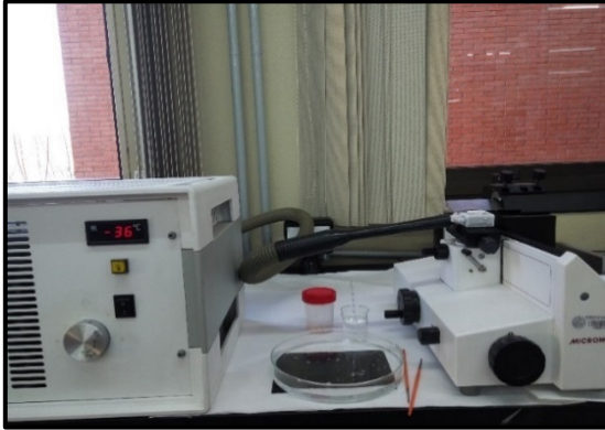
Fig.-8. Microtomo de congelación. La circulación de una corriente de anhídrido carbónico (CO 2 ) por el interior del portabloques provoca el enfriamiento del tejido. La cuchilla pivota sobre un eje fijo en cada sección o corte, originando el avance del portabloques mediante un mecanismo de tornillo (67).
