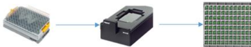
Figura 20. Flujo de trabajo en el biobanco. Las muestras que llegan se alicuotan en tubos Wilmot y se almacenan en cajas de 96 tubos. Éstas son escaneadas en su base, para extraer los códigos únicos de cada tubo en una tabla Excel con DATAPAQ, a la que se asociarán los códigos de cada muestra.
