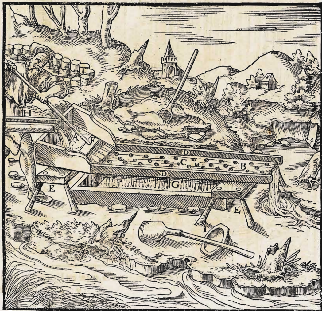
Area caput A. Area B. Foramina C. Tabellæ D. Scabella E. Rutrum F. Lacus G. Canaliculus H. Alueus I.
