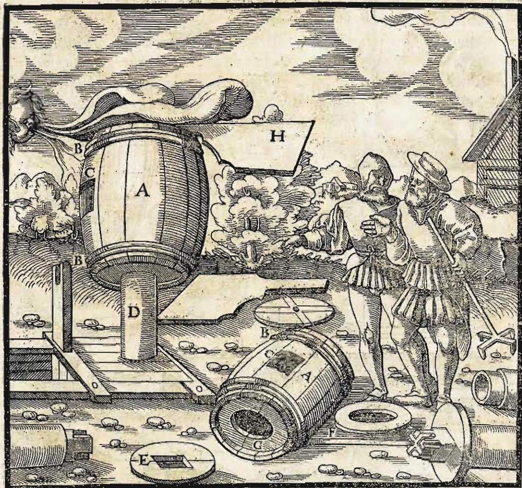
Vas ligneum A. Circuli B. Os spiritalè C. Fistula D. Orbis E. Axiculus F. Foramen quod est in fundo uasis G. Ala H.
