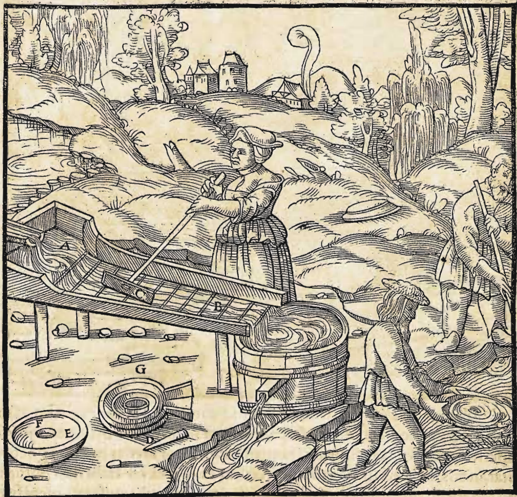
Caput areæ A. Tabellæ transuersæ B. Rutrum ligneum C. Bacillum cuspidatum D. Lanx E. Eius medium cauum F. Lanx striata G.
