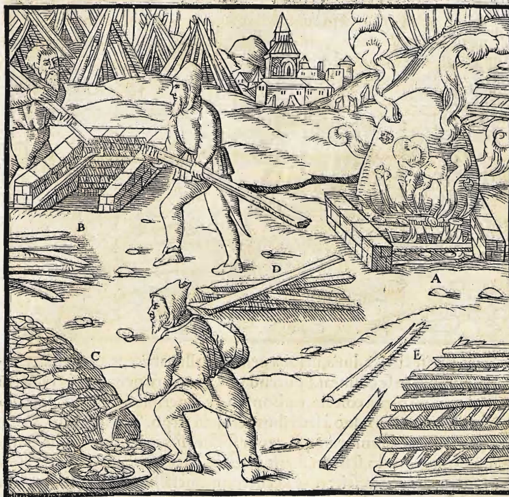
Pyra accensa A. Pyra quæ extruitur B. Vena C. Ligna D. Eorundem strues E.
