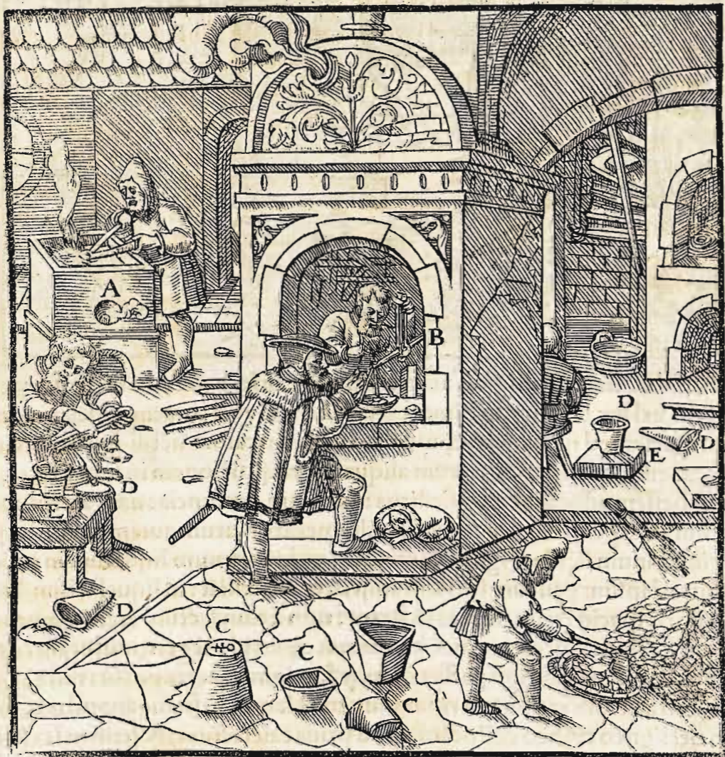
Fornax quae uento foraminibus inspiratur A. Fornax aurificum B. Catinus fictilis C. Catinus ferreus D. Truncus E.
