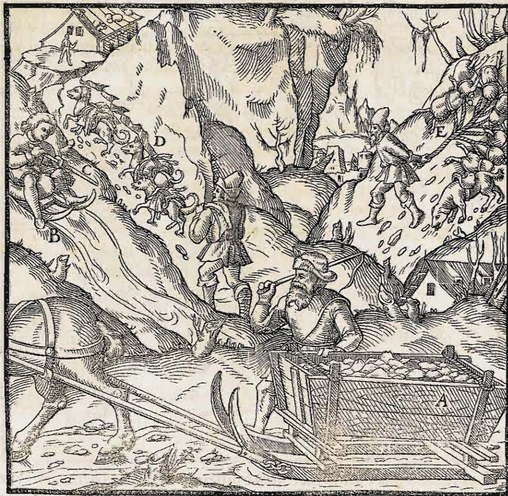
Traha cui imposita est capsula A. Traha cui impositi sunt sacci B. Bacillum C. Canes clitellarij D. Sacci suilli ad funem alligati E.
