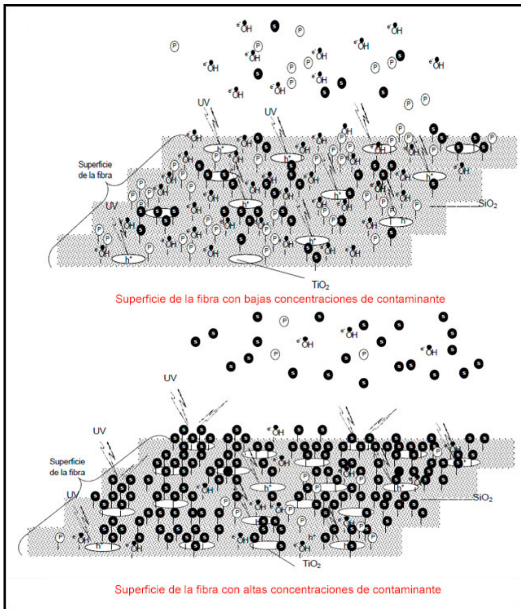
Figura 4.92. Explicación esquemática de la variación de la velocidad de degradación de un contaminante en función de la adsorción superficial del contaminante sobre la fibra.
