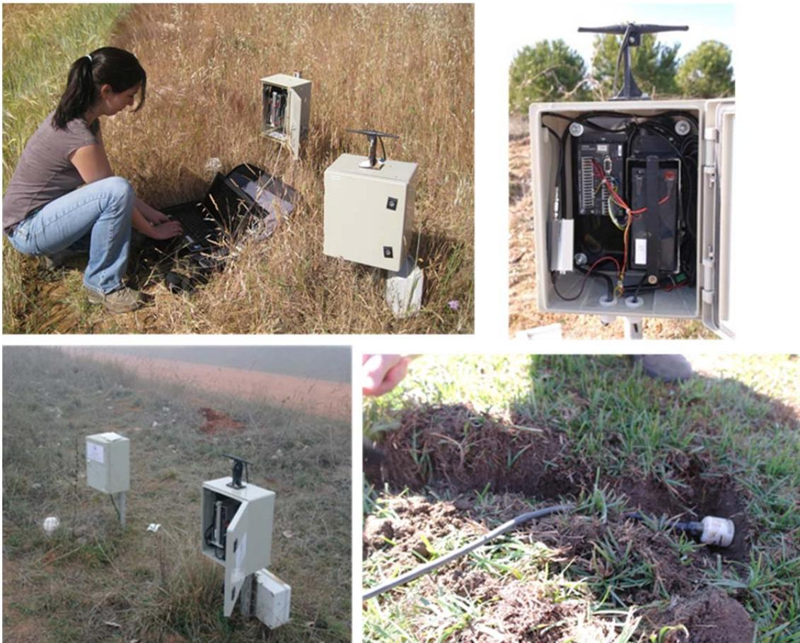
Figura 4.5 Estaciones de medición de la humedad del suelo de REMEDHUS.
