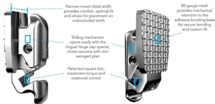
Figura 11. Diseño del bracket Alias®. Ormco <sup>(39)</sup>.
