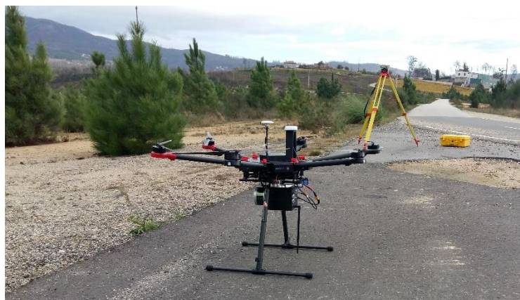
Figura Ap.B.2: Dispositivo montado sobre UAV en campo de pruebas.
