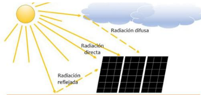
Figura 2. Componentes de la radiación solar. (Fuente: Pontificia Universidad Católica de Chile. Departamento de Ingeniería eléctrica)
