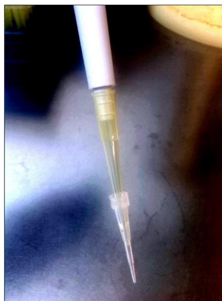
Figura 14: Fotografía del sistema de dos puntas de micropipetas acopladas, utilizada para la disgregación mecánica.
