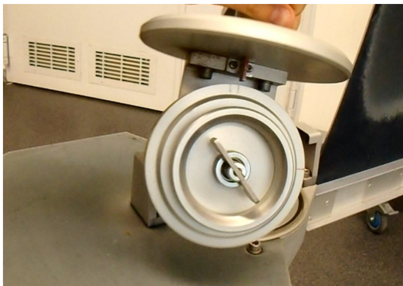
Imagen 2. 2. Detalle del mecanismo de relojería del tambor.
