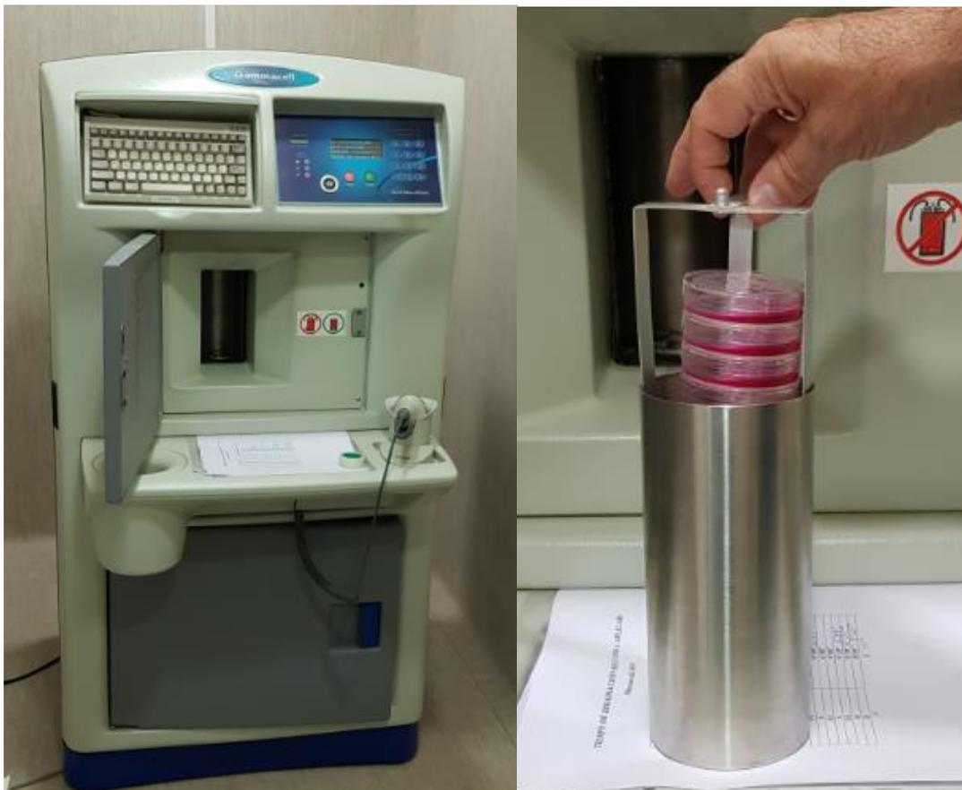
Figura 22. A. Equipo *Gammacell 1000 Elite*. B. Placas de 30 mm a irradiar.
