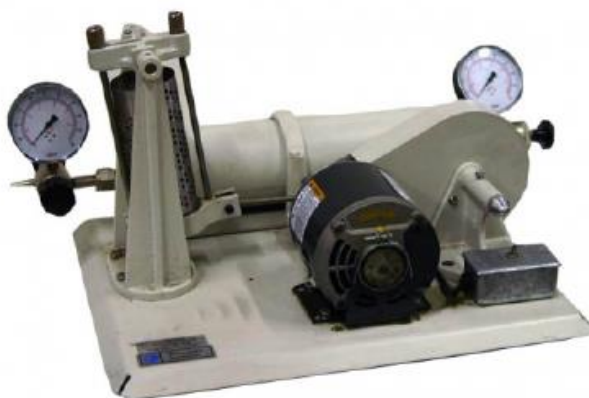
Figura 3.3: Hidrogenador utilizado para las reacciones en atmósfera de hidrógeno.
