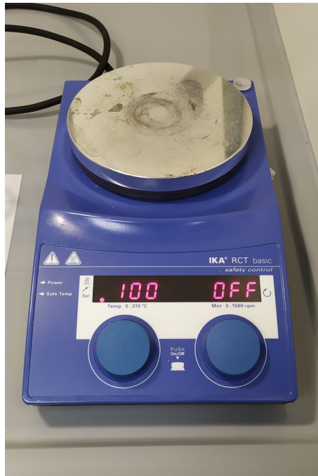
Figura 2.4: Hot Plate usado para que se adhiere más material sobre el sustrato
