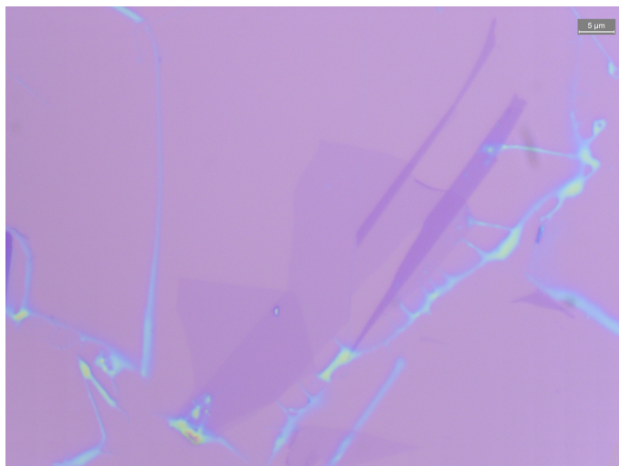
Figura 2.5: Flake que encontramos y usaremos para la fabricación de la heteroestructura. Como podemos ver hay un par de esquirlas de grafito que produjeron algún problema a lo largo del proceso.
