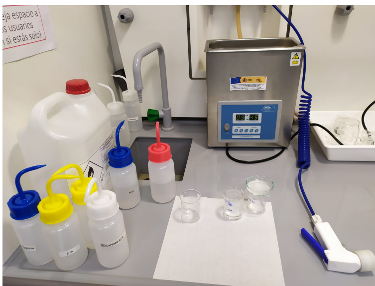
Figura 2.1: Zona de trabajo para esta parte, donde se ven los vasos con los compuestos, la máquina de ultrasonidos y la pistola de nitrógeno
