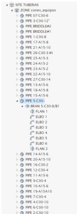
Imagen 53: configuración de la línea 5-C30-8" en AVEVA E3D
