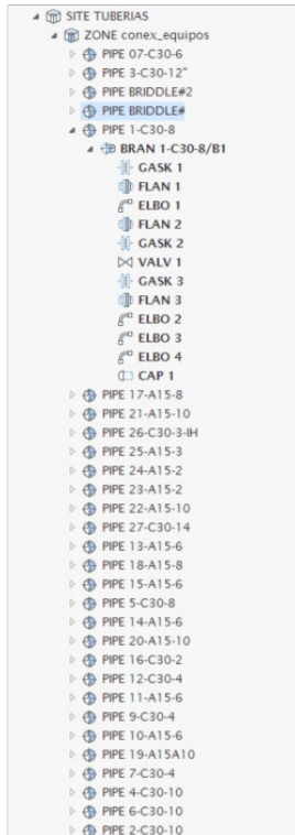
Imagen 45: configuración de la línea 1-C30-8" en AVEVA E3D
