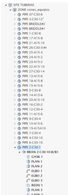
Imagen 47: configuración de la línea 2-C30-10" en AVEVA E3D
