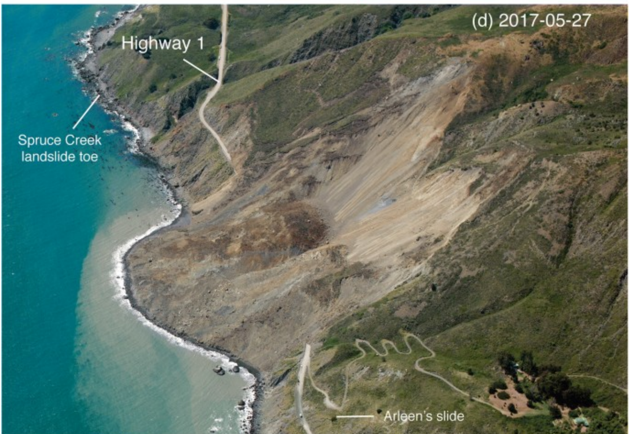
Figura 3.1-1: Ubicación y características del deslizamiento de Mud Creek, incluyendo su situación previa y posterior al fallo catastrófico. Fuente: Jonathan A. Warrick et al. (2019)
