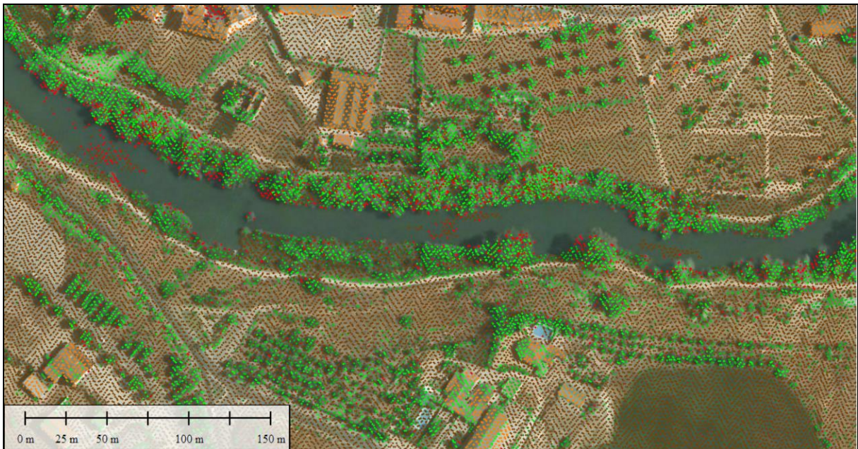
Figura 29. Retornos clasificados procedentes del LiDAR del PNOA. Obsérvese la ausencia de puntos en el cauce, que posteriormente será interpolado por los puntos de tierra más cercanos.
