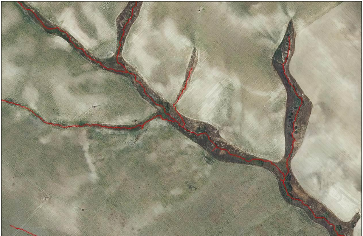
Figura 19. Arroyos de escorrentía delineados automáticamente a partir de Modelo Digital de Elevaciones derivado de nube de puntos LiDAR
