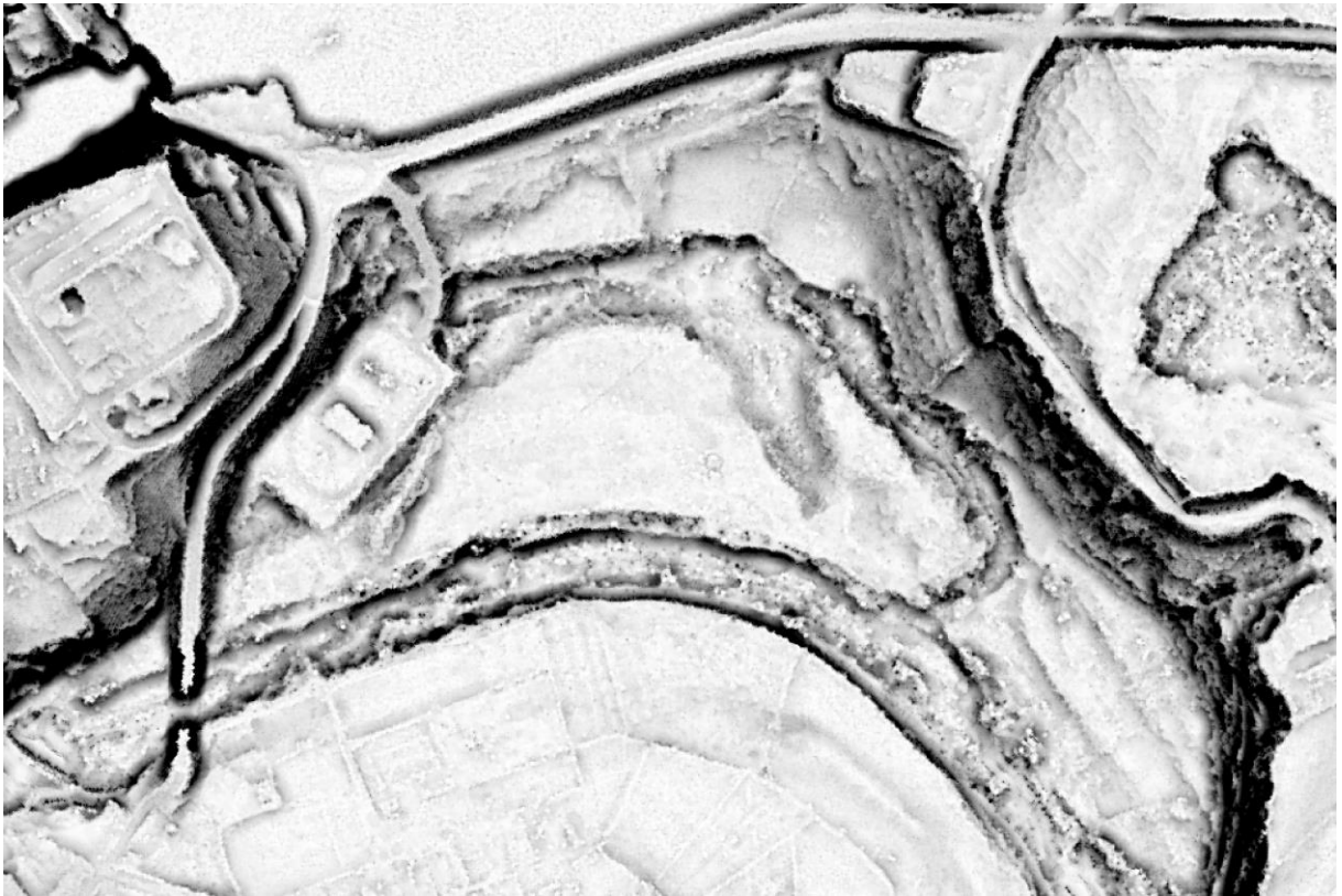
Figura 11. Ejemplo de Sky View Factor donde se observa parte del cauce actual y un cauce secundario, anteriormente cauce principal.
