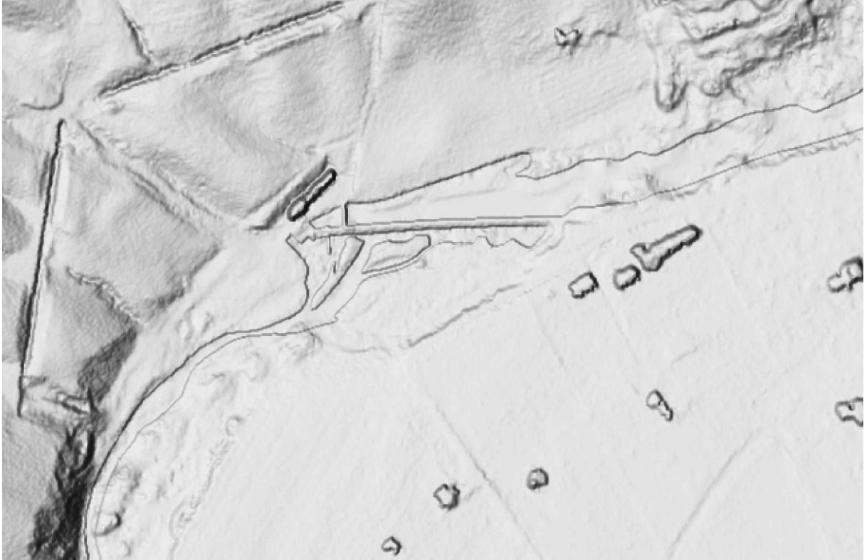
Figura 32. Hillshade multidireccional que del modelo LiDAR. Se puede observar el tratamiento preliminar dado al lecho del río y el azud.
