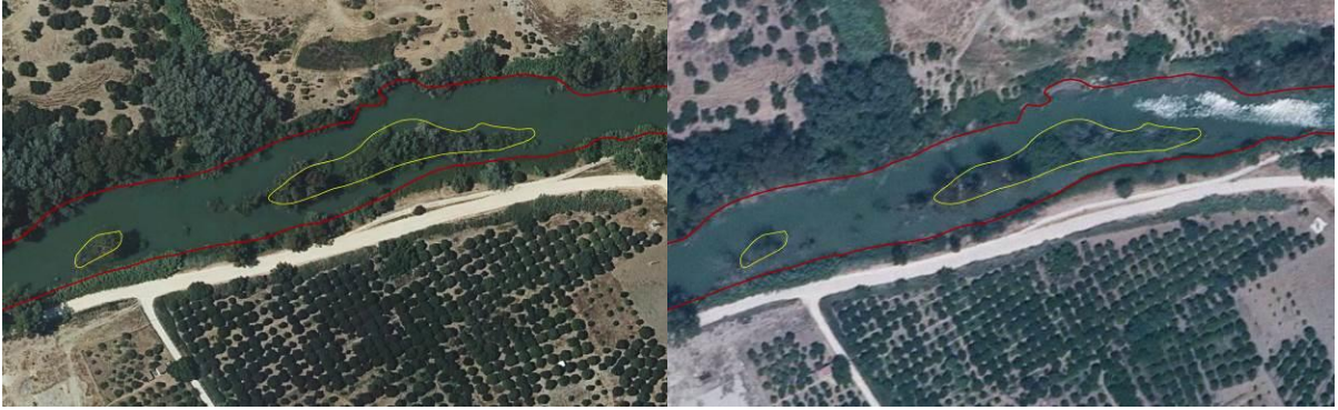
Figura 31. Ortofotos correspondientes a 2019 y 2013, a izquierda y derecha respectivamente. En rojo, queda trazada la línea del cauce. En amarillo, las islas sedimentarias identificadas.
