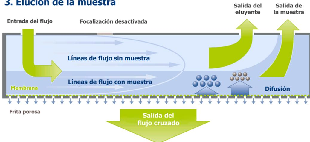
Figura MM-2. Principio de separación de partículas por fraccionamiento por flujo campo-flujo asimétrico (AF4). Ilustraciones adaptadas y traducidas al castellano con permiso de Postnova.
