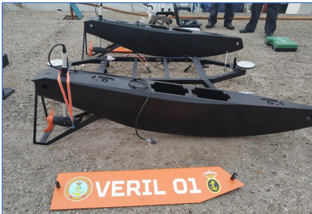
Figura 16. Detalle Patines y placas protectoras VERIL 01.
