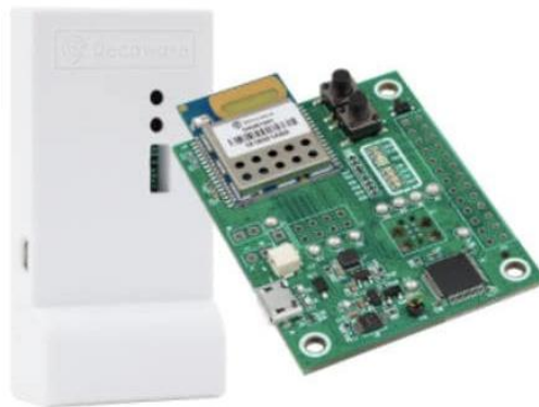
Figura 9: Estructura Tags y Anchors DWM1001C
