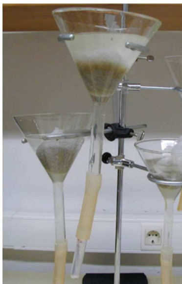
Figura 3.1. Aparato Baermann para la obtención de L3 de Strongyloides venezuelensis .
