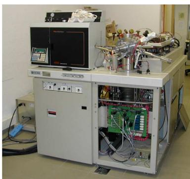
**Figura 7.** Espectrómetro VG TS-250
