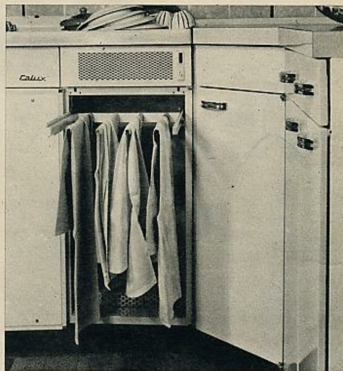
Mueble de cocina equipado con secador. Las barras donde se cuelgan los paños pueden desplazarse hacia adelante para facilitar la operación. A través de una rejilla metálica que va instalada en el mueble, sale una corriente de aire caliente que seca los paños con rapidez.
