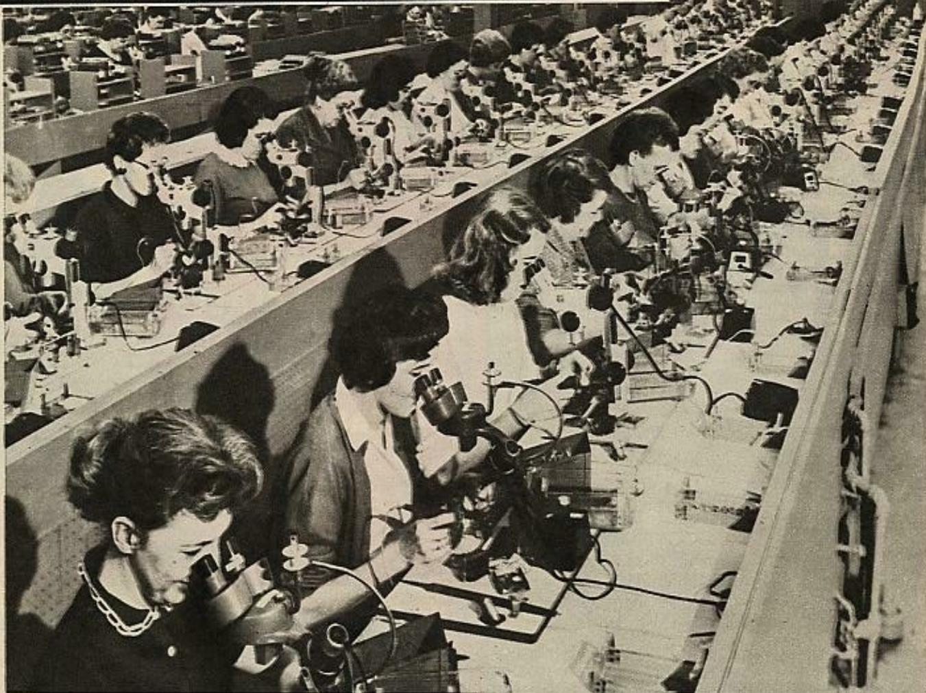
Obreras usando microscopios para soldar transistores y otros elementos pequeños eléctricos, con sus cables ultrafinos. Este procedimiento será innecesario si los circuitos moleculares reemplazan a los transistores, resistencias, condensadores y los demás pequeños componentes usados hoy. Los circuitos moleculares serán producidos enteramente por máquinas
