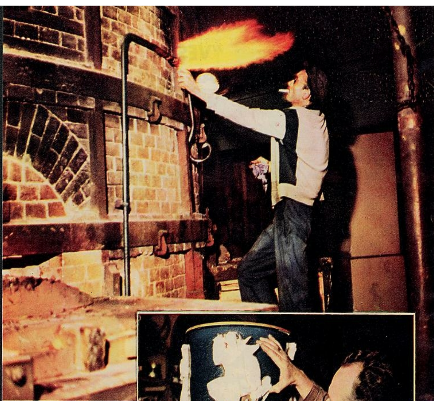
Preparando la «muffla» u horno: es decir, graduando la temperatura del mismo para conseguir el grado calorífico necesario para la cocción.
