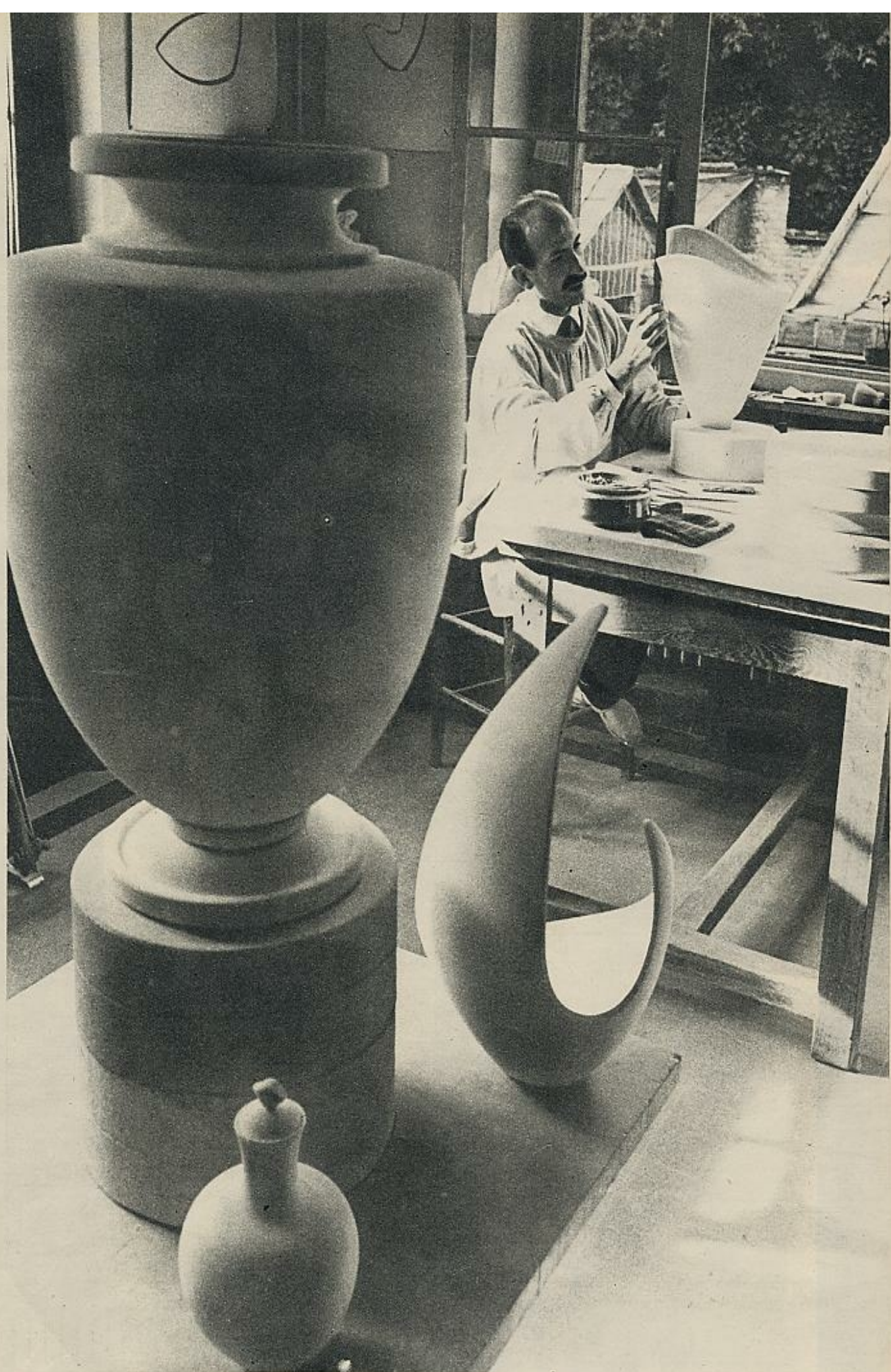
Una vez conseguida la porcelana en el horno, han de corregirse las imperfecciones mediante continuas pulimentaciones, para pasar a la sección de decoración.
