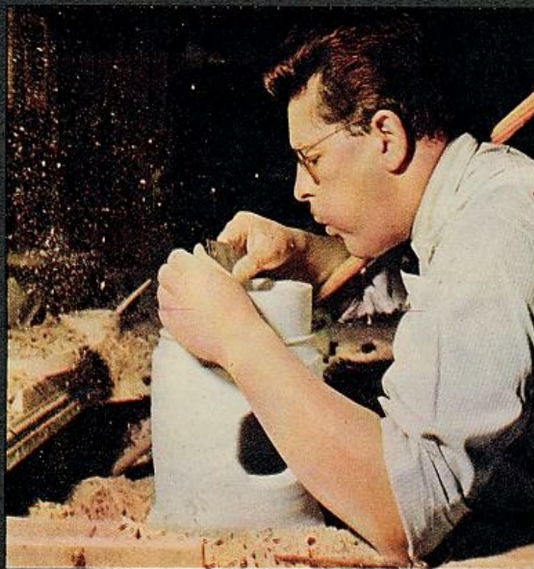
Después de efectuada la primera cocción, el especialista lija el «bizcocho» para limar las posibles imperfecciones y pasarlo al taller de decoración en perfecto estado.
