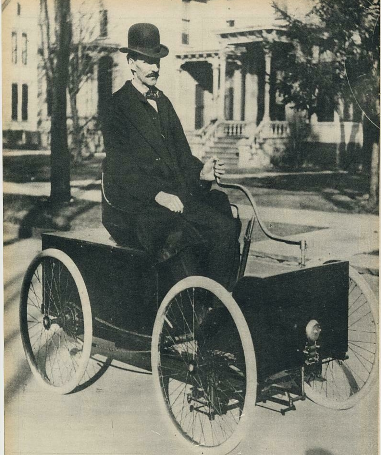
Henry Ford al volante de su primer coche, el «cuadríciclo». Este primitivo «Ford» tenía gomas de bicicleta, motor de dos cilindros con cuatro H. P. y hacía una velocidad de 10 millas por hora
