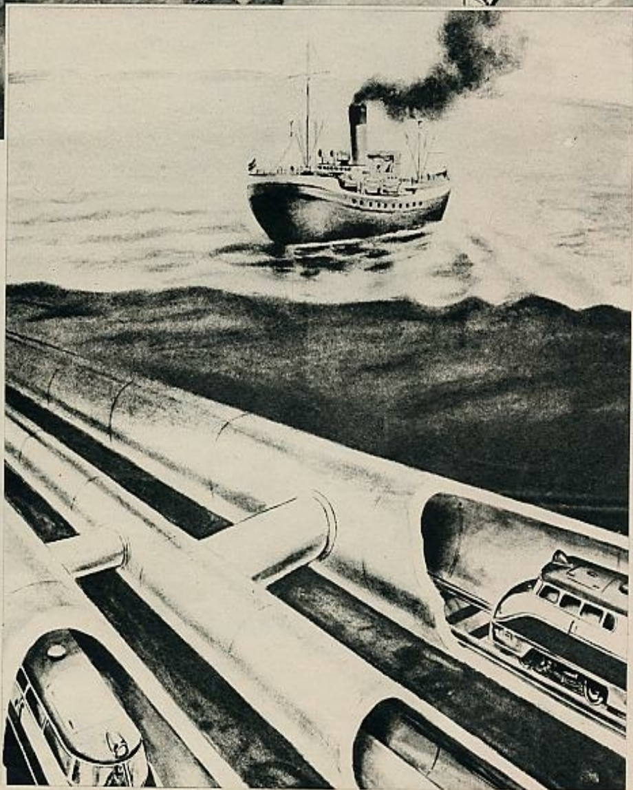
Foto superior: diseño de dos plataformas sobre la superficie del Canal; una serviría para el dragado, otra para la colocación del tubo. El dibujo inferior muestra los tres conductos: dos de ellos serían para vías de ferrocarril eléctrico; por el central se ventilarían los dos conductos laterales.
