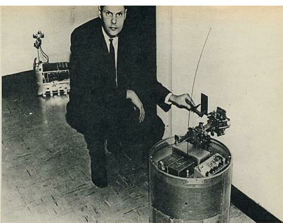
Se trata de un pequeño robot con una memoria elemental creada electrónicamente. Es capaz de autoabastecerse, cuando su carga se termina, en el enchufe más próximo que encuentra. Un juguete maravilloso.
