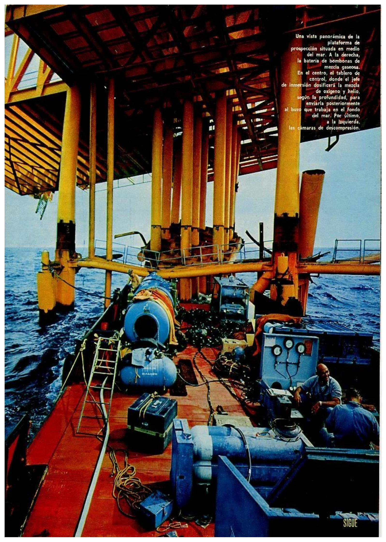
Una vista panorámica de la plataforma de prospección situada en medio del mar. A la derecha, la batería de bombonas de mezcla gaseosa. En el centro, el tablero de control, donde el jefe de inmersión dosificará la mezcla de oxígeno y helio, según la profundidad, para enviarla posteriormente al buzo que trabaja en el fondo del mar. Por último, a la izquierda, las cámaras de descompresión.
