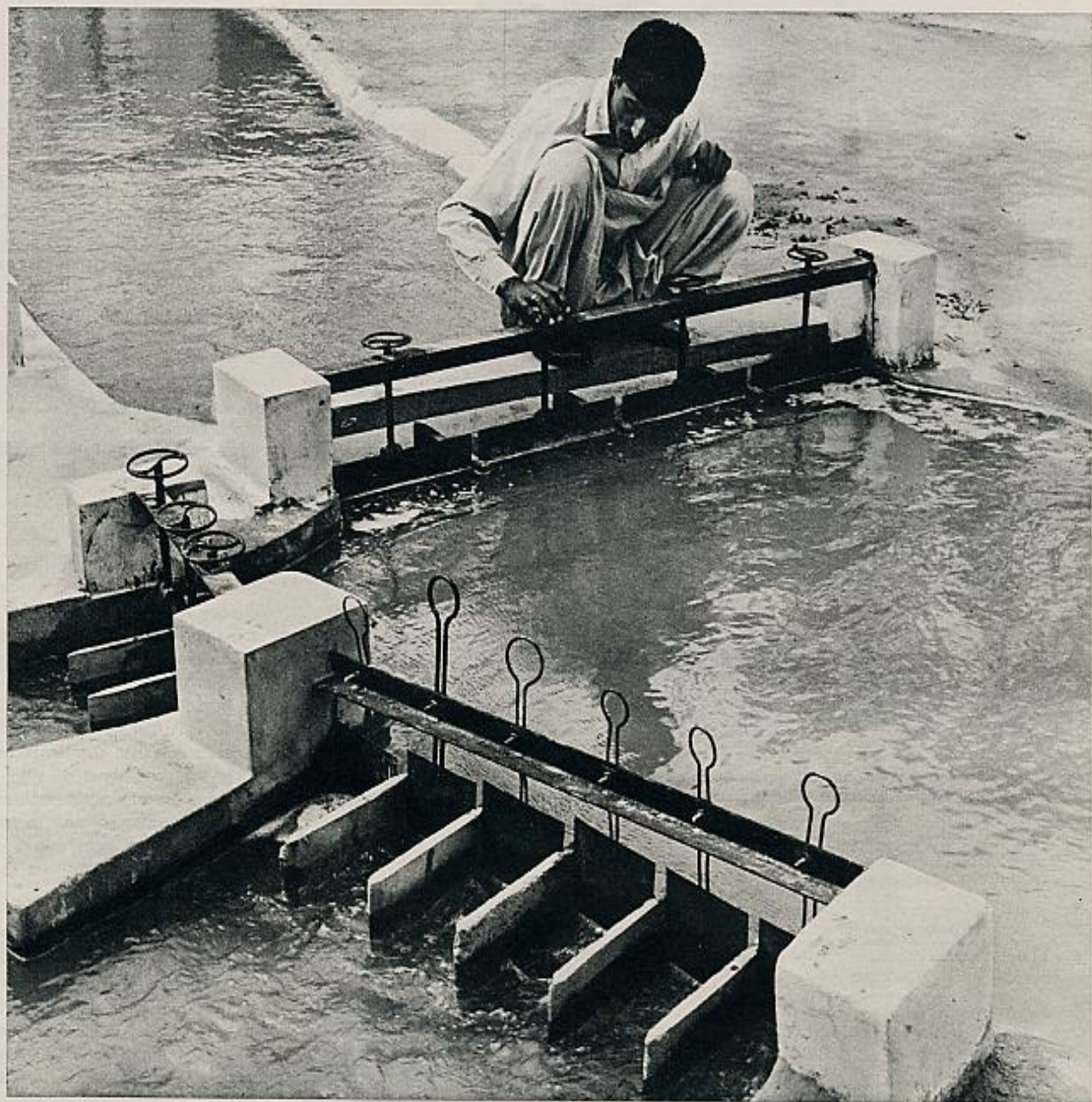
La sal del Indico agosta los terrenos. Contra ella, el agua dulce del Indo. Los modelos de presas para riego se verifican previamente en el «Irrigation Research Institute» de Nandipur, mediante construcciones maquetadas en miniatura, como la de arriba, que forma parte de la presa de Mangla.
