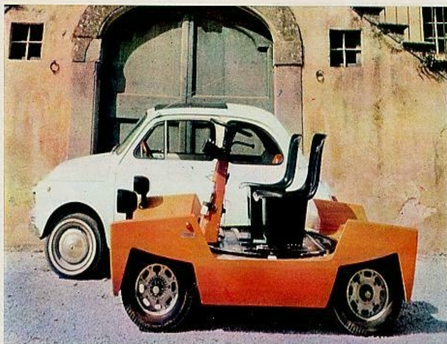
La comparación con el «seiscientos» pone de evidencia las ventajas utilitarias del «Urbanina». En la foto inferior, el pequeño automóvil desmontado en sus varias partes. Puede advertirse la cabina de los pasajeros, colocada sobre un anillo giratorio de acero: puerta a gusto del cliente. Una creación de porvenir.
