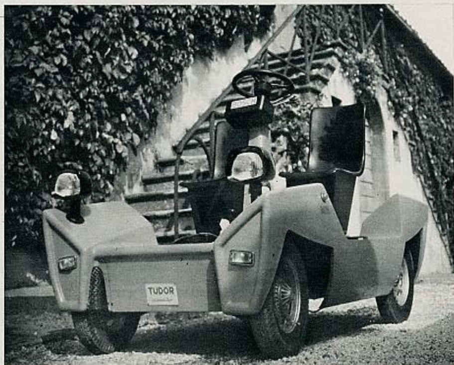
En la foto superior, el «Urbanina» sin carrocería: un descapotable eléctrico. En la inferior, los creadores del minicoche: a la izquierda, el marqués Piero Girolamo Bargagli Bardì Bandini, promotor de la empresa; en primer término, el mecánico e inventor de este sensacional minicoche, Narciso Cristiani.
