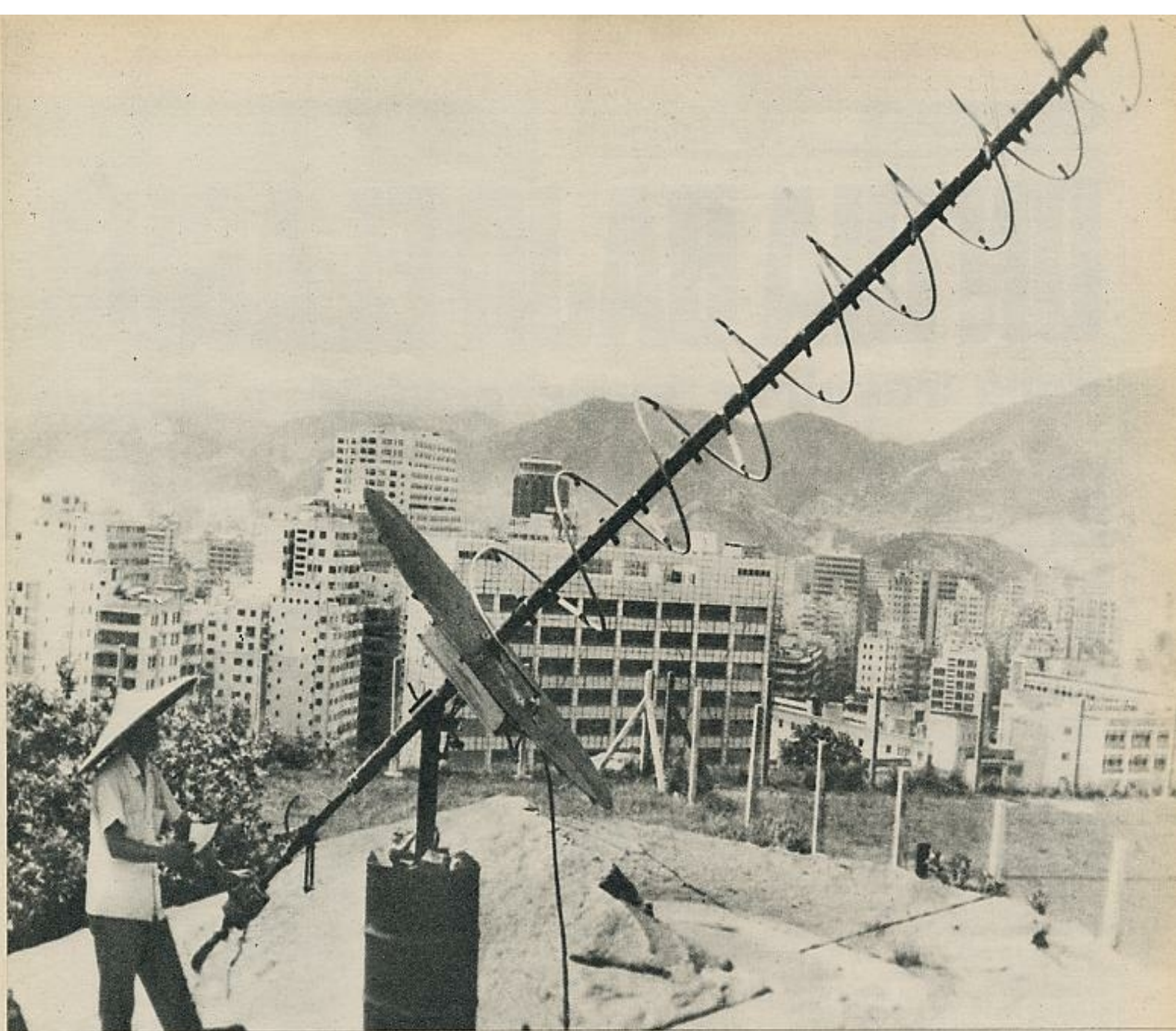
Esta antena, instalada en el Real Observatorio de Hong-Kong, permite la recepción de imágenes tomadas por los satélites norteamericanos "Nimbus" y "Esso". de esta forma, la estación de recepción registra el avance de los ciclones, como sucedió con el tifón "Judy", y advierte acerca de la proximidad de los huracanes.
