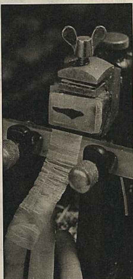
Corte de un bloque de tejido con microtomo en un laboratorio de vigilancia farmacéutica. El Estatuto de autonomía de Cataluña es muy ambicioso en lo que respecta a la protección farmacéutica.
