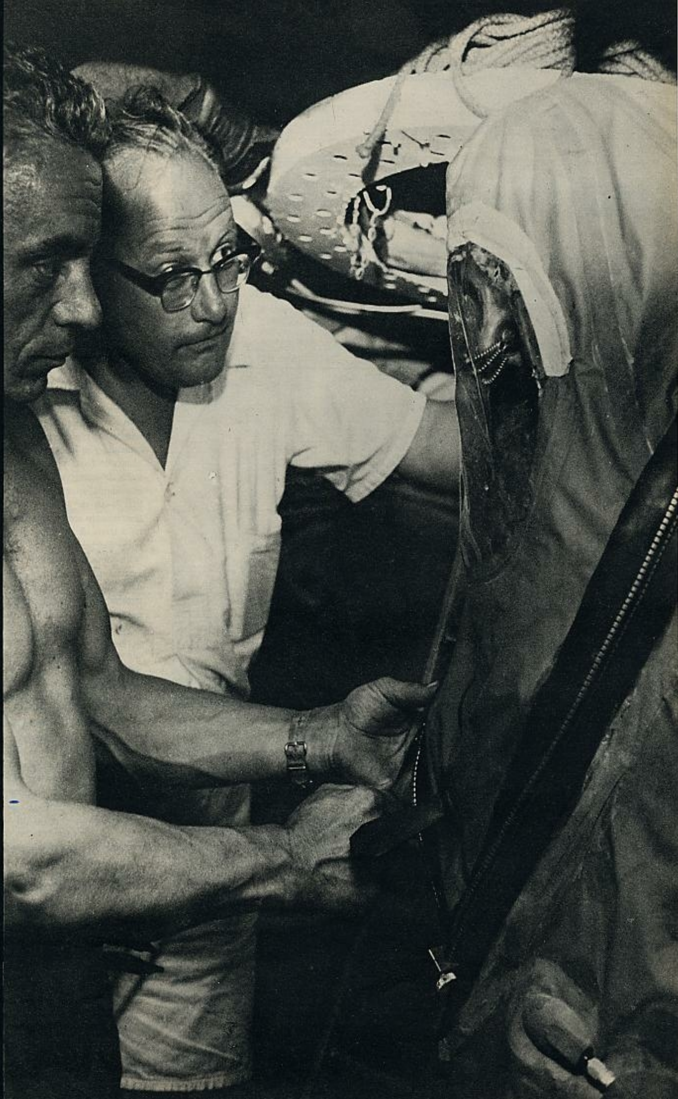
«La capucha hinchable» es una especie de traje espacial que, a través de una cámara de aire, aísla al náufrago del medio adverso en el que tiene que desenvolverse.
