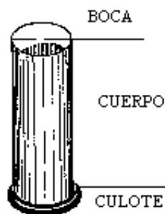
Figura 1.10. Partes de la vaina cilíndrica.
