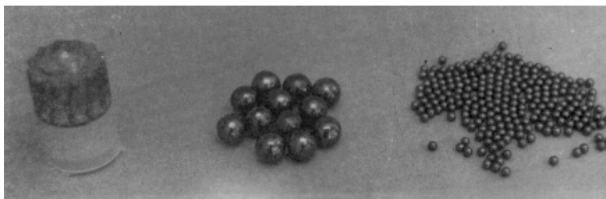
Figura 1.17. Tipos de proyectiles de un cartucho semimetálico.
