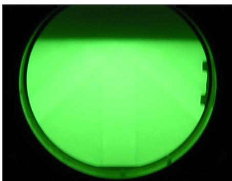
Figura 5.1: Fotografía de la pantalla del RHEED obtenida cuando se analiza una superficie de una oblea de Si(001) tratada con vapores de HF.
