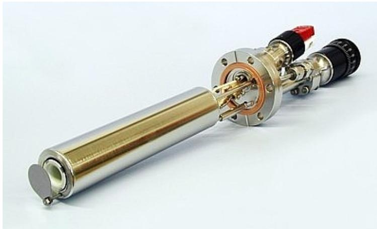
Figura 2.4: Fotografía de una celda de efusión, o celda Knudsen, tomada antes de su instalación en un sistema de MBE [10].
