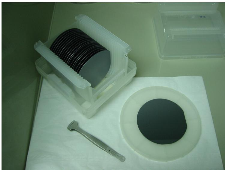
Figura 3.1: Imagen de una de las obleas de 4 pulgadas (10 cm de diámetro) empleadas como sustrato en los crecimientos.
