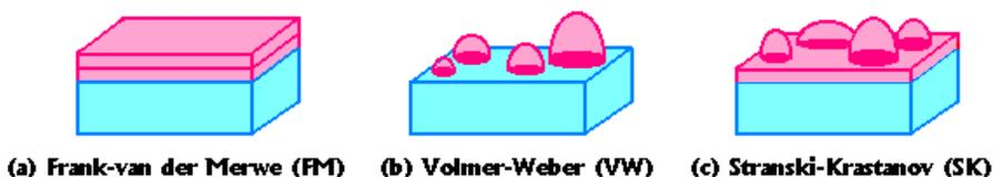
Figura 2.10: Representación de los tres tipos de crecimiento de capas en un sistema de MBE, (a) crecimiento Frank-van der Merwe (FM)(b) crecimiento Volmer-Weber (VW) (c) crecimiento Stranski-Krastanov (SK) [15].
