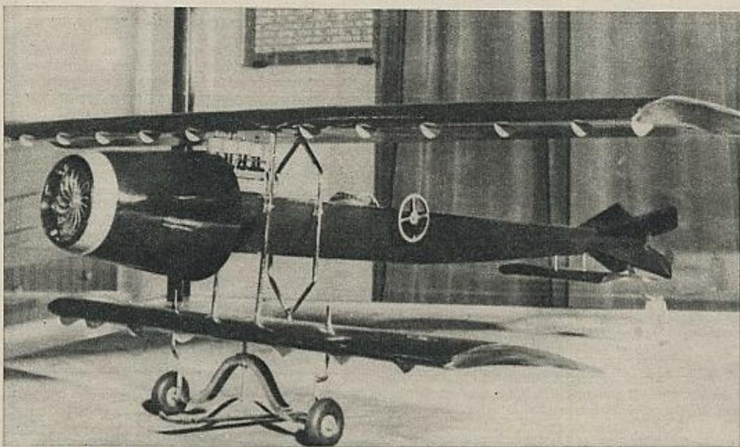
Maqueta del avión diseñado y pilotado por Coanda en 1910, primer avión a reacción del mundo.
