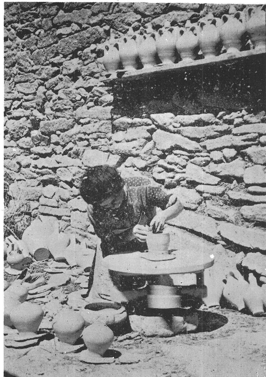
Foto n.º 3. — Alfarera trabajando en el corral. En primer término, el cántaro típico de Moveros. — Foto n.º 4. — Alfarera en pleno trabajo. Véase que la pieza no asienta directamente sobre la rueda, sino sobre la galga sobre ella colocada. Las piezas que están ante la rueda, a la izquierda, son botijos sin asa aun ni pitorros. Sobre la alfarera, una tabla en la que secan al sol unas barrilas .
