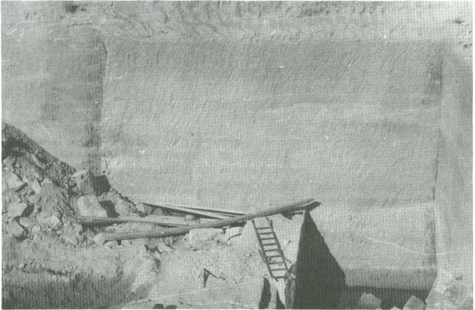
Fig. 14.- Canteras de Sanchón, en Villamayor. Vista del frente de explotación activa. La potencia es de 5.30 m (Nov. 1981).
