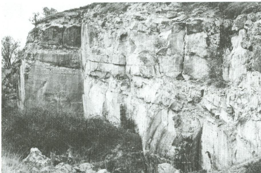
Fig. 17.- Canteras de Santibáñez del Río. La capa superior presenta mucho lajamiento. La inferior presenta buenas condiciones de explotación. Abandonadas desde 1920.
