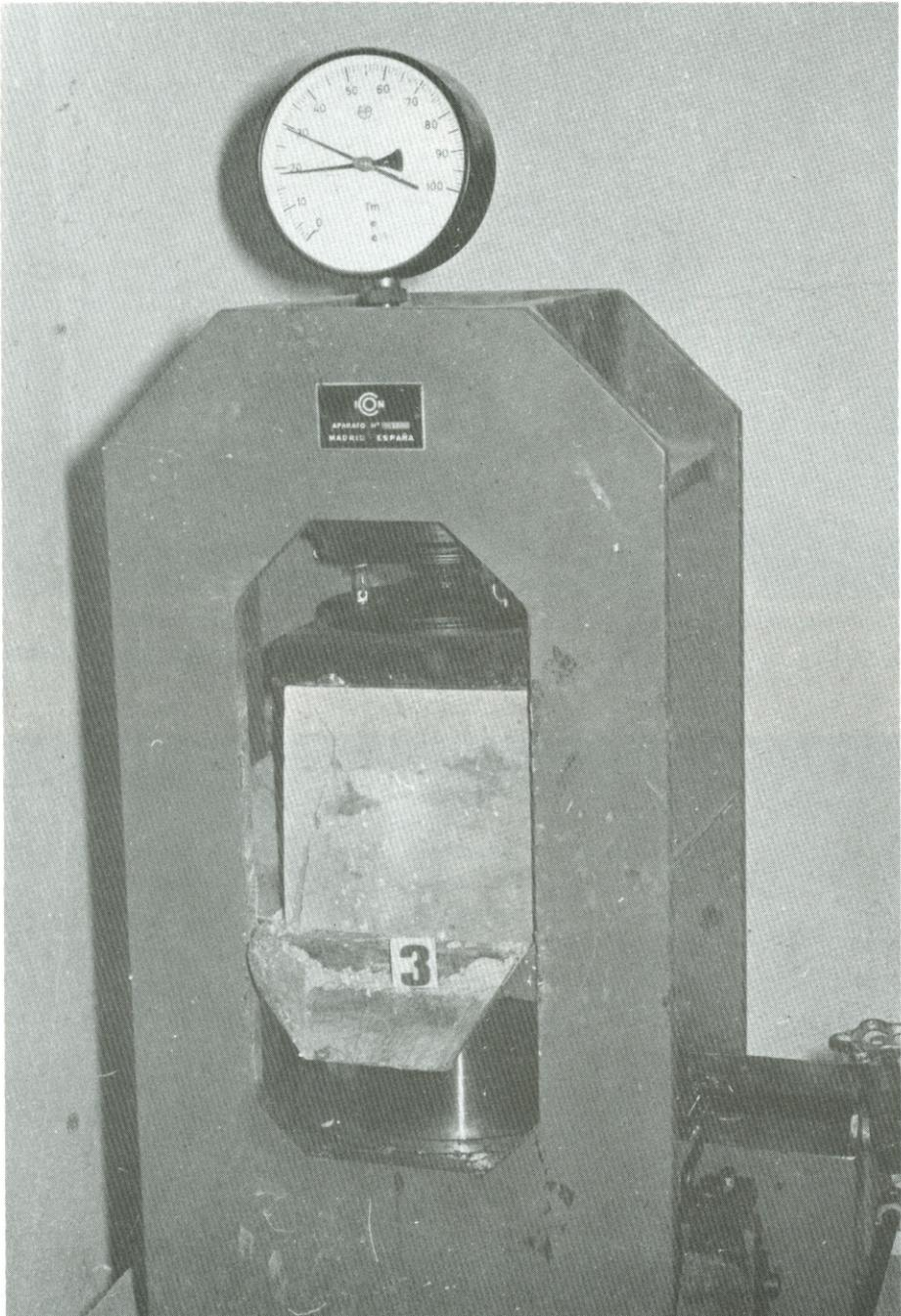
Fig. 30.- Prensa ICON para rotura de probetas. Se encuentra colocada la muestra 3ª (con 100% de humedad) que soportó una fuerza de 19.5 Tm.
